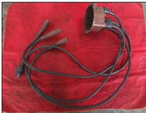
Fig. 4-51 Cables de tensión ACCEL
