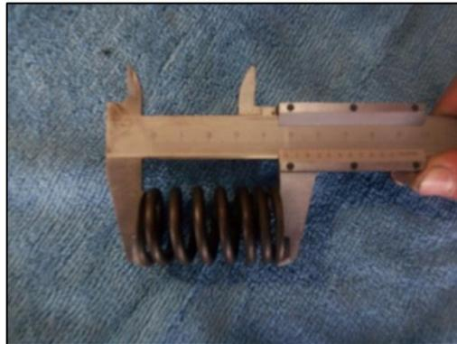
Para culminar el análisis de muelles se calcula la frecuencia natural de resonancia con lo que se determinó que no es necesario utilizar un muelle interno en vista de que el muelle elegido entra en resonancia a los 9 615 rpm como se determina en las siguientes ecuaciones y la máxima velocidad angular del cigüeñal en pista y estático es de 7 560 y 9 500 revoluciones por minuto respectivamente, tal como se especifica en las tablas 5-2 y 5-8.
