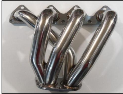
En caso de tener un motor de seis cilindros se recomienda hacer dos múltiples de 3 - 1 siempre ubicados los tubos extremos con extremos y medios con medios y no siguiendo el orden de encendido para evitar el choque de ondas de presión. Para determinar con exactitud el diámetro de la caja de expansión se debe obtener el diámetro del tubo de escape primario ya que estos se acoplan directamente entre sí.
