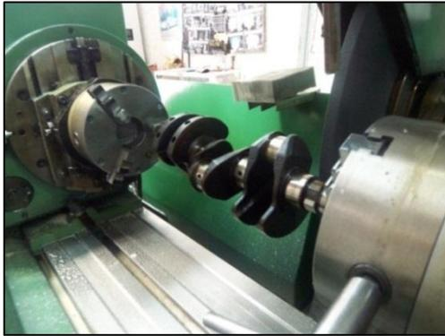
Fig. 4-10 Maquina para rectificar cigüeñales
