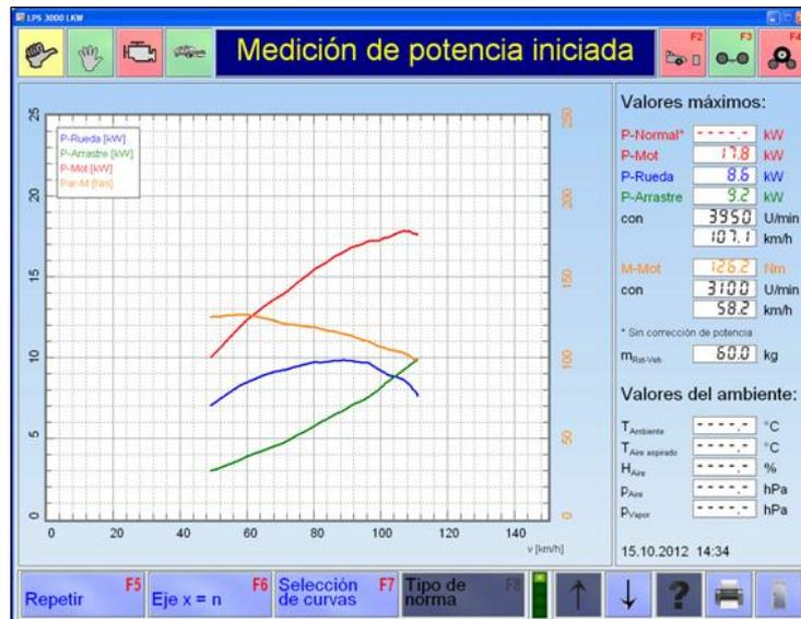
Antes de ser repotenciado el motor G10 estándar usado alcanza una potencia del motor de 17,8 kW a 3 950 rpm. Al multiplicar este valor por el factor de corrección 1,01495 obtenido bajo la misma normativa DIN 70020 en la que se encontraba el banco se calcula la potencia normal requerida como se observa en la siguiente ecuación:
