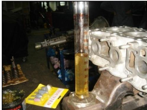
5. Se vierte el aceite de la probeta hasta llenar la cámara de combustión.
