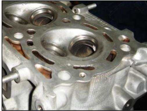
3. Se untan con grasa los asientos y cabezas de las válvulas para una vez colocadas sellan herméticamente las cámaras y eviten la fuga de aceite al momento de realizar la prueba.
