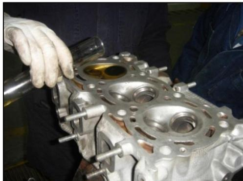
6. Se calcula el volumen de la cámara, restando el volumen inicial de la probeta menos el volumen final, obteniendo como resultado  $25,35 \text{ cm}^3$ .
