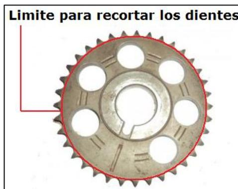
3. En la polea # 2 se realiza un corte interior hasta dejar un agujero cuyo diámetro permita que se acople perfectamente la placa de la polea # 1.
