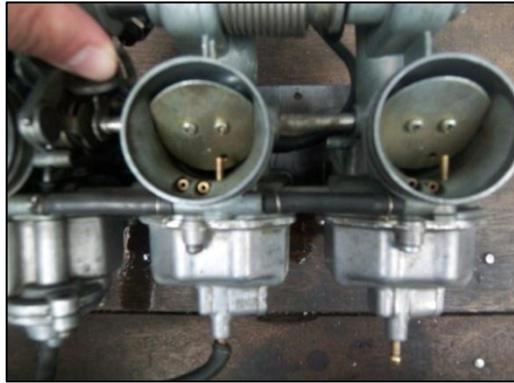
3. Con una jeringa se inyecta gasolina en cada cuba y se coloca una probeta a la salida de cada inyector, luego de diez aceleradas a fondo se retiran las probetas y se observa que todos los carburadores hayan inyectado la misma cantidad de combustible.
