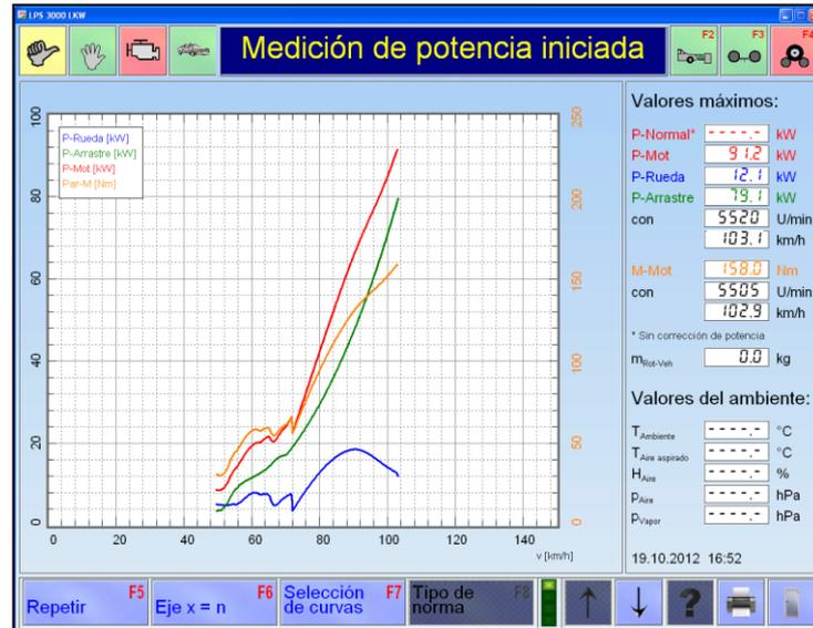
Luego de ser repotenciado el motor G10 los valores de potencia del motor han incrementado significativamente alcanzando los 91,2 kW a 5 520 rpm y para determinar la potencia normal requerida también se debe multiplicar por el factor de corrección obtenido en ese momento de 1,00689, dando como resultado el valor calculado mediante la siguiente ecuación:
