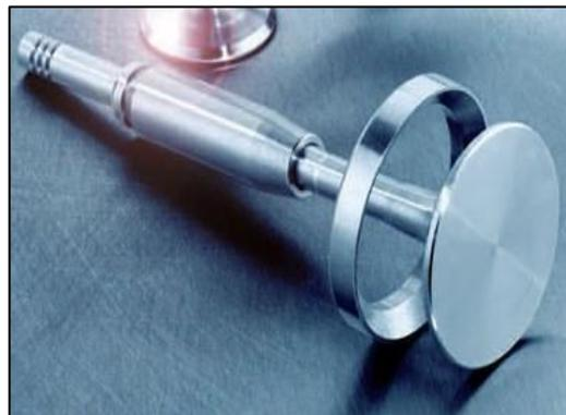
Lo que se pretende conseguir en el caso de ser necesaria la sustitución o modificación de las válvulas de admisión es básicamente una mejor aspiración y llenado de los cilindros, siempre asegurando que se cumpla la condición de proporcionalidad entre la mezcla que circula por la sección de paso y la que aspira el pistón, como determina la ecuación 2-1. Para el caso de válvulas de escape esta condición puede despreciarse en vista de que su función es la de evacuar los gases combustionados.
