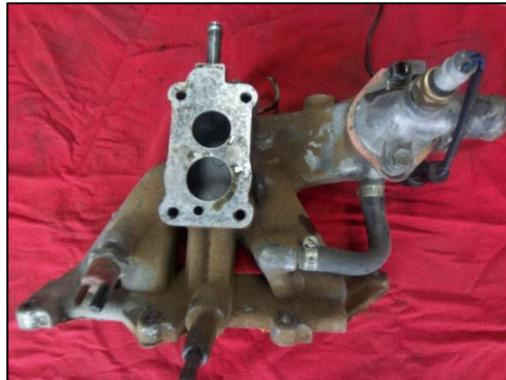
Al colocar un carburador para cada cilindro se debe fabricar un múltiple que se acople a cada uno de manera independiente, el mismo que fue mandado a construir en hierro en base a los datos teóricos que se detallan y un diámetro de tubo calculado mediante las siguientes ecuaciones:
