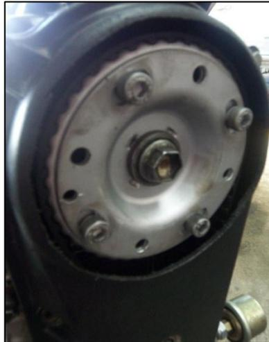
1. Se coloca un goniómetro en la polea del cigüeñal y un reloj comparador en la cabeza del pistón número 1, determinando que el mismo se encuentre en punto muerto superior y en etapa de compresión.
