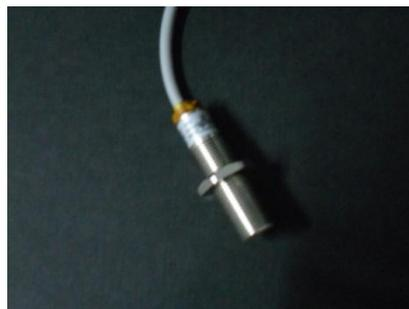
Al colocar el núcleo del sensor Hall a una distancia de 1 a 3,5 mm respecto a un material ferro magnético (placa metálica) (Fig. 3-26), las líneas de flujo del imán permanente cambian de dirección. Cuando el vehículo está detenido, no se produce movimiento en las líneas de flujo, por lo que no se induce corriente a la bobina; pero al arrancar el vehículo, un objeto ferro magnético ingresará y abandonará el campo
