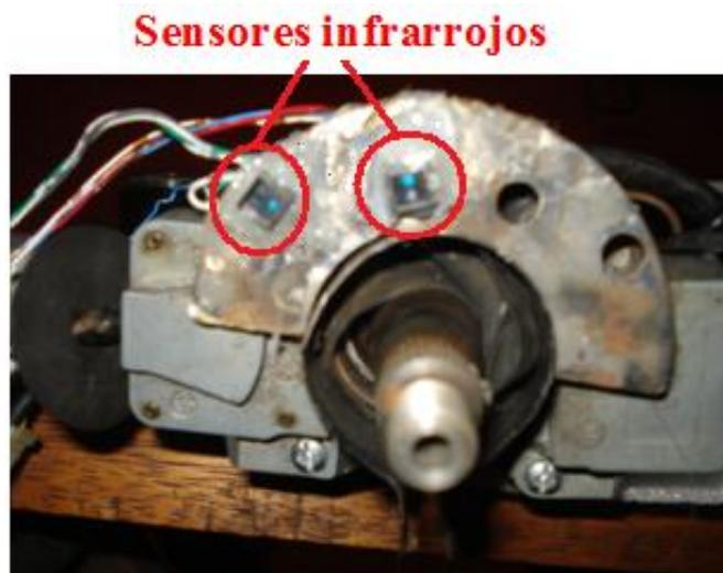
La señal de velocidad y régimen motor se generarán con la implementación de sensores acoplados al vehículo de tal manera que proporcionen la información necesaria para generar la asistencia, como son la señal de la velocidad de desplazamiento del vehículo y el régimen de giro del motor.
