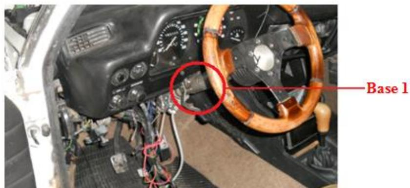
Fig. 3-26 b) Base inferior para la fijación de la nueva columna de dirección
