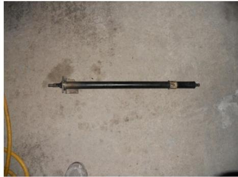
Fig. 3-4 Soporte superior de Columna
