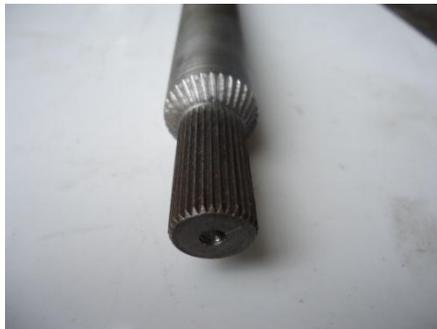
Fig. 3-16 lado de acoplamiento con el eje articulado
