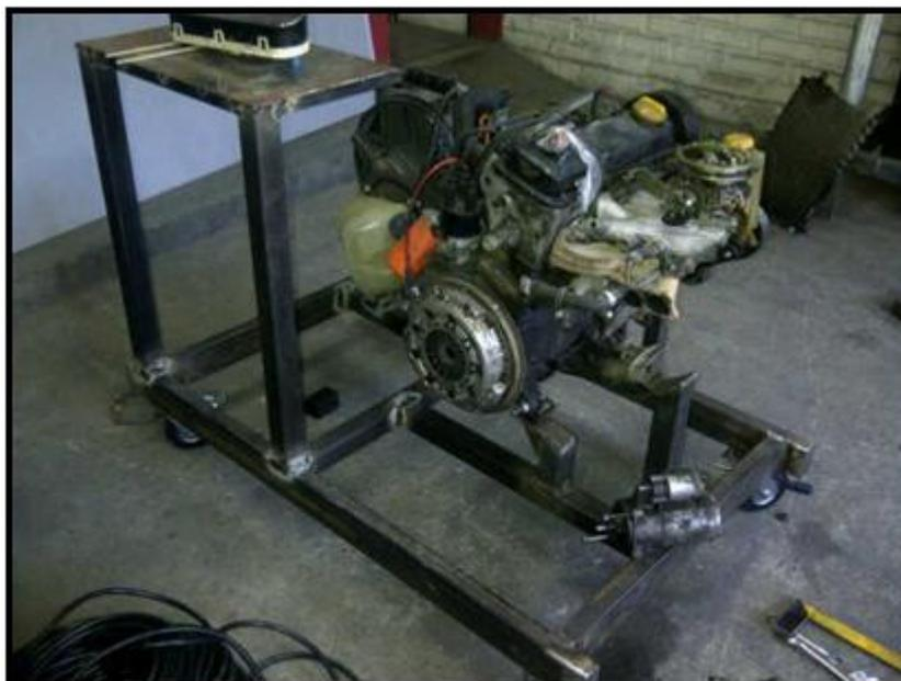
**Figura 3.2.** Estructura en proceso y motor acoplado.
