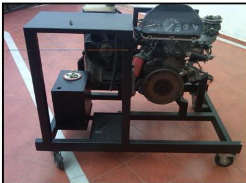
**Figura 3.3.** Estructura terminada y motor acoplado.
