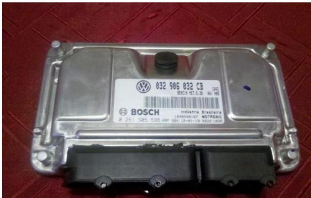
**Figura 1.18.** Unidad de Control Electrónico.
