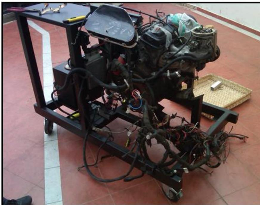
**Figura 3.4.** Montaje de los Componentes del Sistema.
