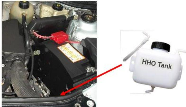
**Figura 2. 10.** Posible ubicación del depósito en Renault Clio
