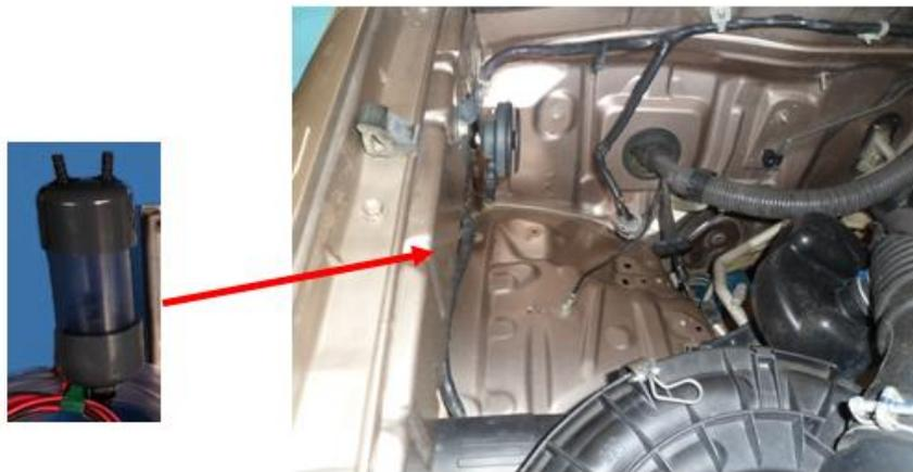
**Figura 2. 7.** Posible ubicación del burbujeador en Toyota Hilux
