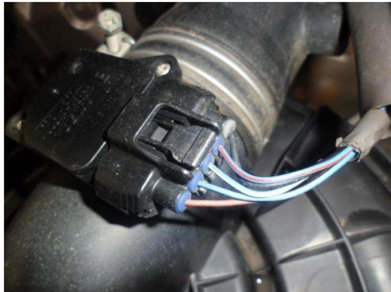
**Figura 2. 20.** Ubicación del sensor MAF en Toyota Hilux
