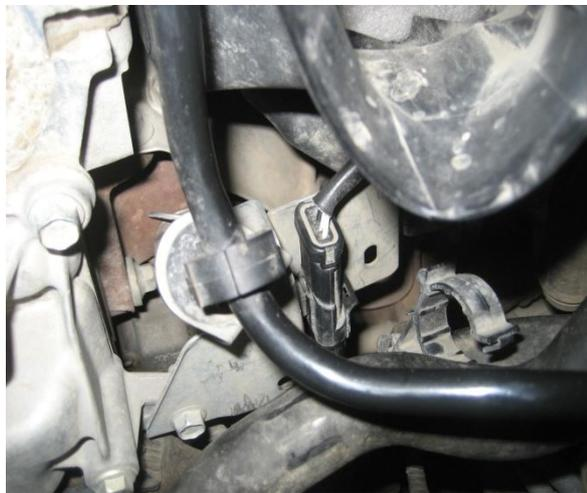
**Figura 2. 28.** Ubicación del sensor de oxígeno en Renault Clio
