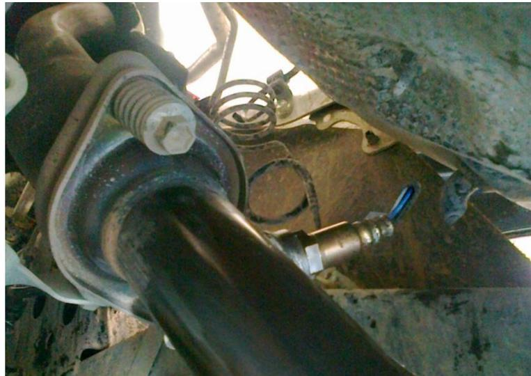
**Figura 2. 22.** Ubicación del sensor de oxígeno en Toyota Hilux
