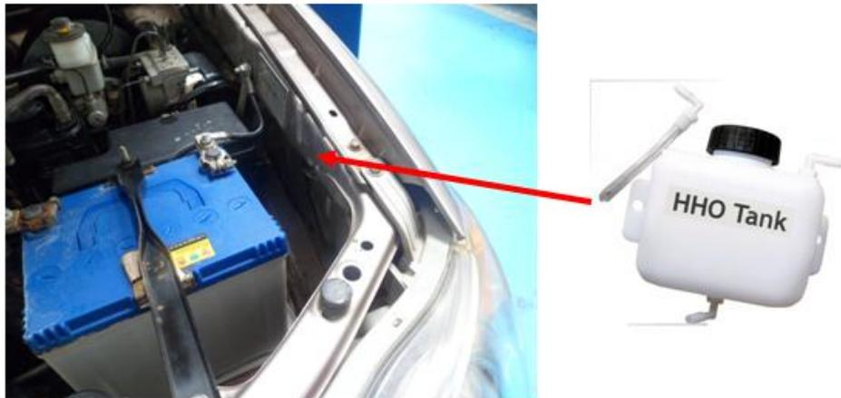
**Figura 2. 6.** Posible ubicación del depósito en Toyota Hilux
