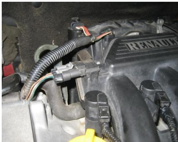
**Figura 2. 30.** Ubicación del sensor MAP en Renault Clio
