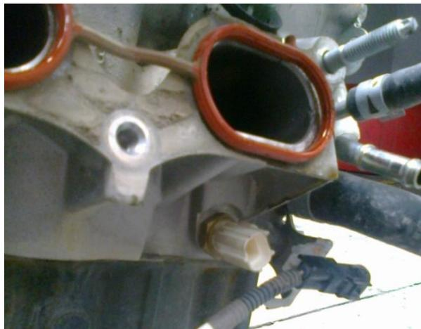
**Figura 2. 18.** Ubicación del sensor ETC en Toyota Hilux
