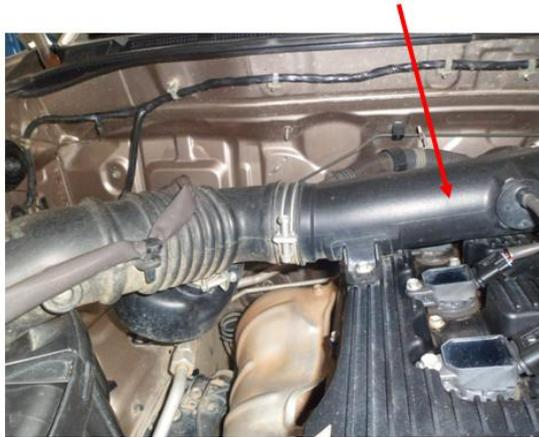
**Figura 2. 8.** Posible ubicación del conector de HHO en Toyota Hilux
