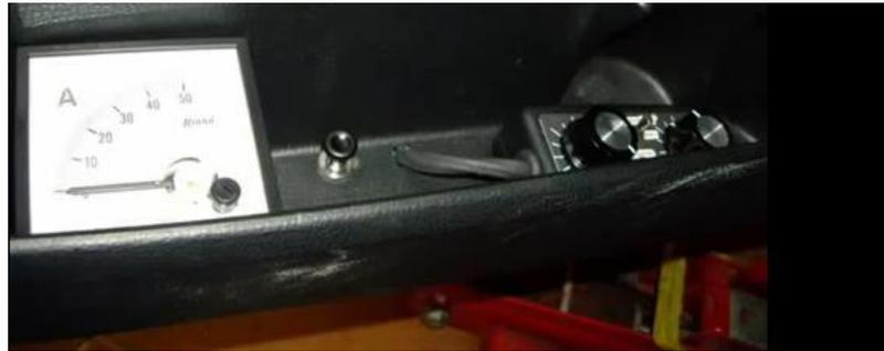
**Figura 2. 16.** Posible ubicación del amperímetro
