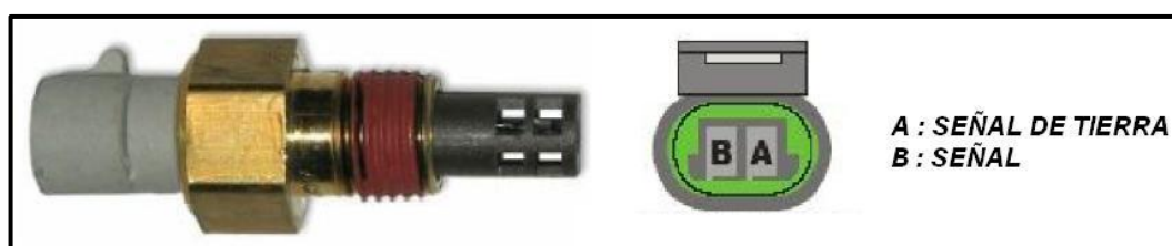
Figura 3.26: Sensor IAT de dos cables.
