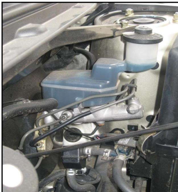
Figura 3.4 Bomba de frenos (cilindro principal)
