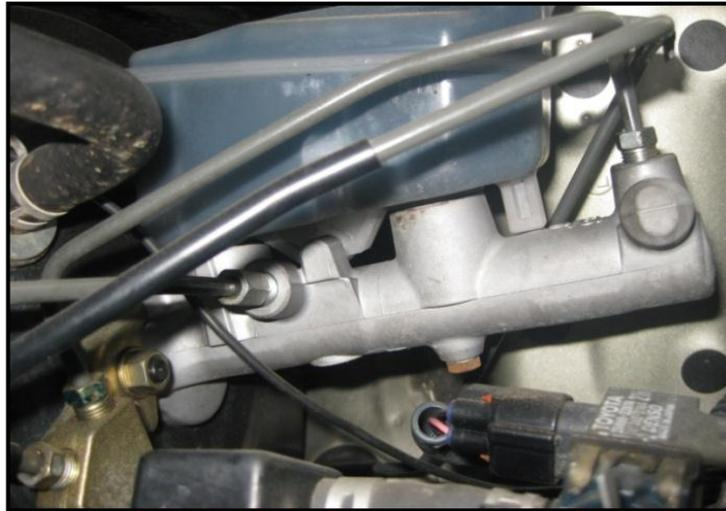
Figura 3.5 Salida de presión de los 2 circuitos de la bomba
