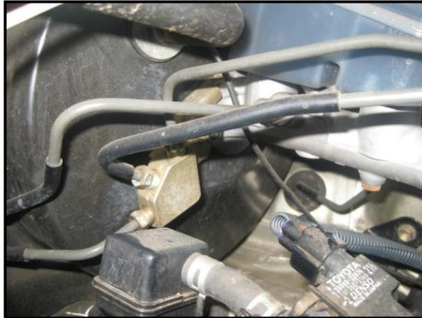
Figura 3.40 Válvula repartidora de presión
