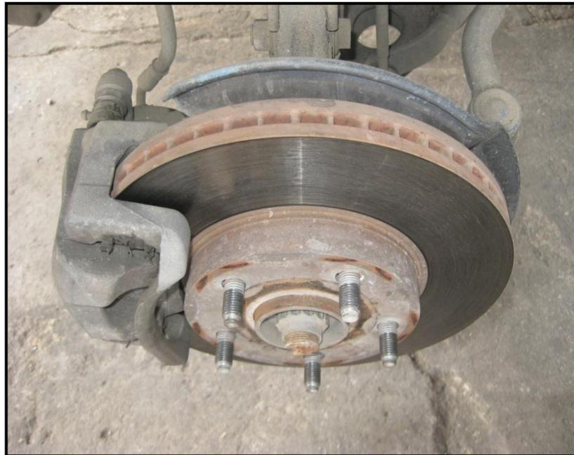
Figura 3.8 Disco de freno, eje delantero
