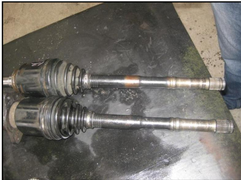
Figura 3.31 Semiejes con puntas retiradas
