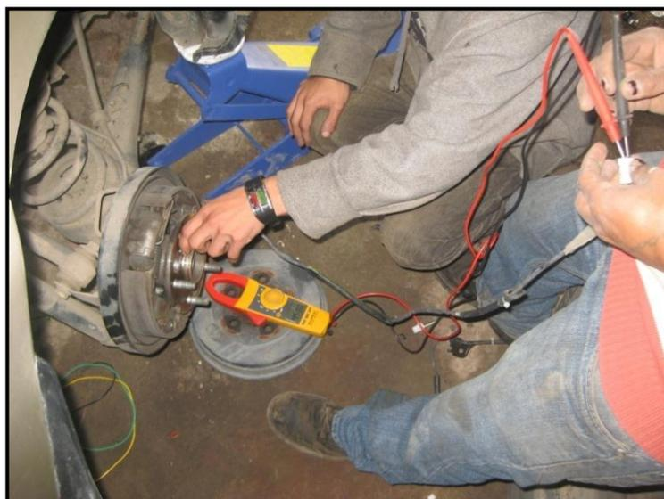
Figura 3.56 Verificación de los sensores posteriores
