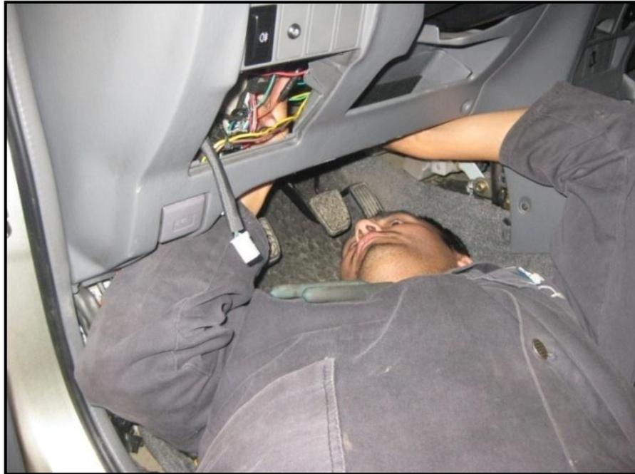
Figura 3.67 Instalación de las líneas del ABS al OBDII
