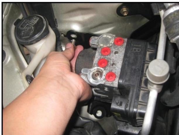
Figura 3.36 Colocación de pernos de unión módulo con compartimento del motor
