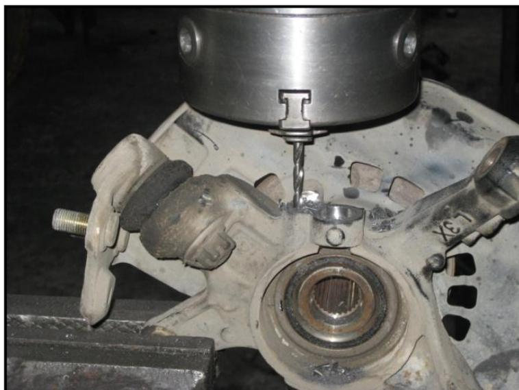
Figura 3.30 Agujero para tornillo de sujeción del tornillo
