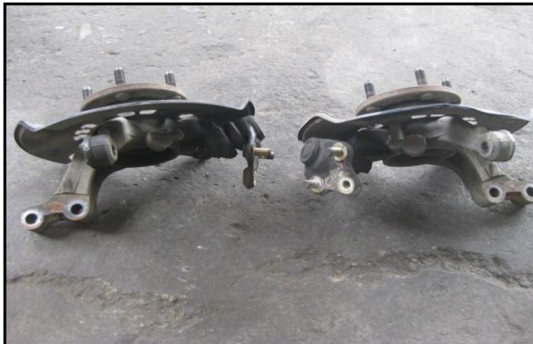
Figura 3.26 Manguetas desmontadas
