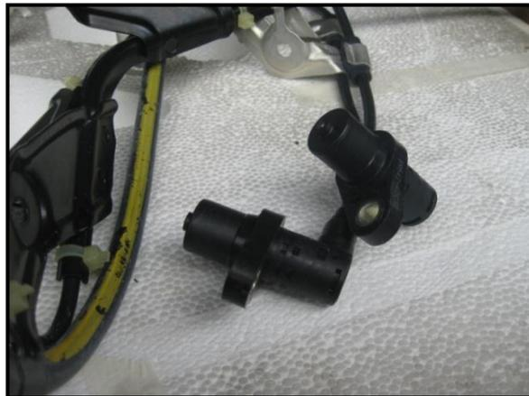
Figura 3.10 Sensores inductivos de tipo polo plano
