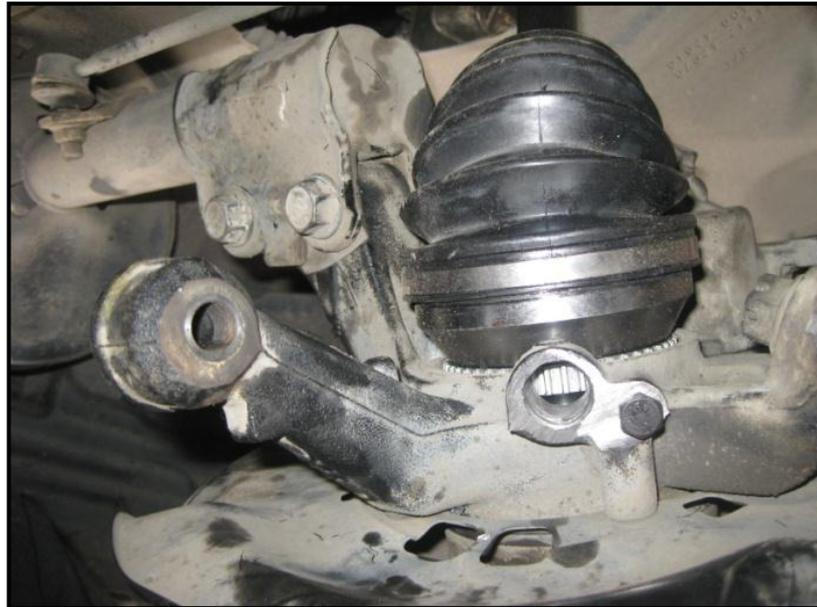
Figura 3.34 Agujero del sensor y rueda fónicas armadas
