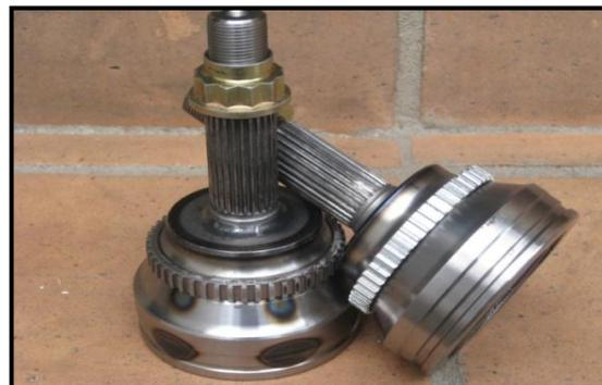
Figura 3.9 Punta de eje con rueda fónica
