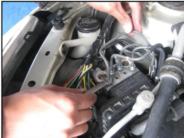
Figura 3.70 Purgado del grupo hidráulico ABS
