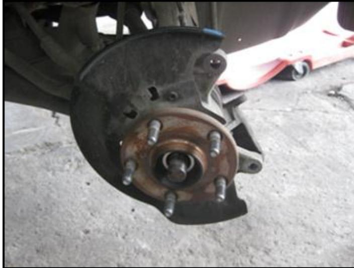
Figura 3.25 Mangueta y punta de eje
