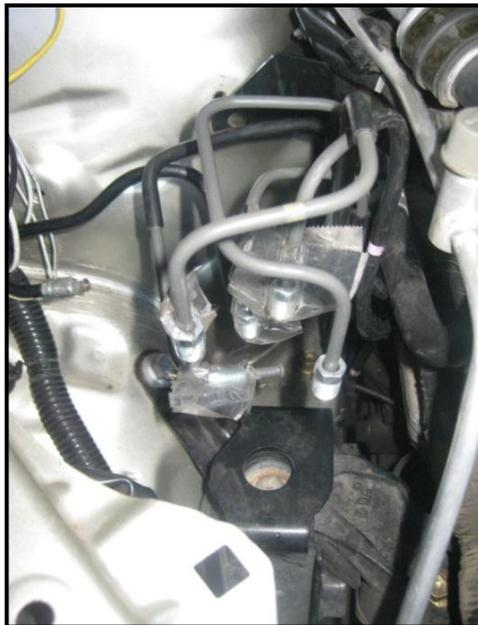
Figura 3.46 Cañerías para sistema ABS instaladas
