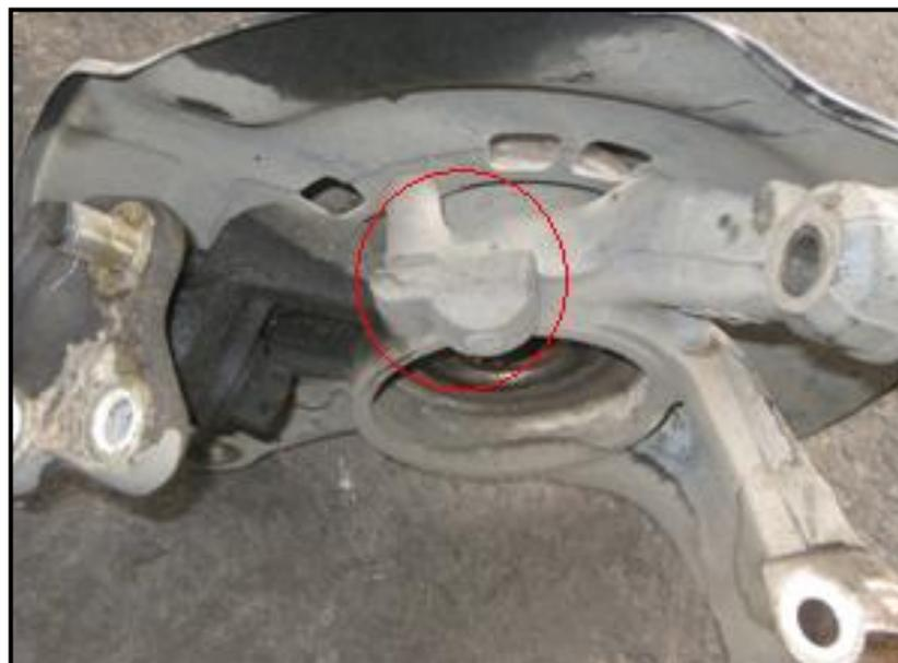
Figura 3.27 Zona de acoplamiento del sensor de revoluciones
