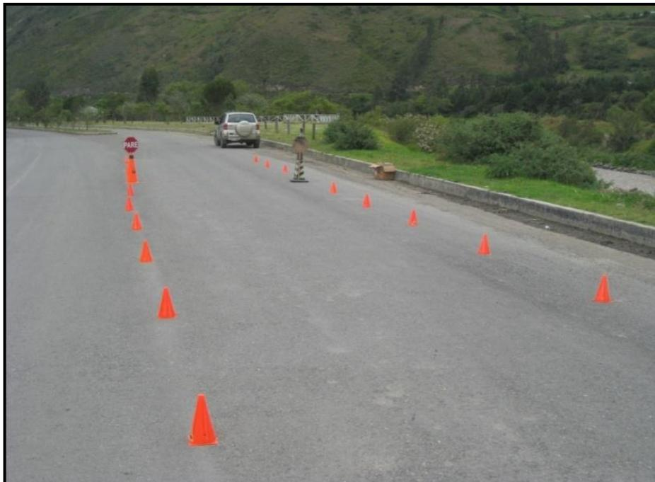
Figura 5.1 Estructura de la pista para las pruebas de frenado en pavimento
