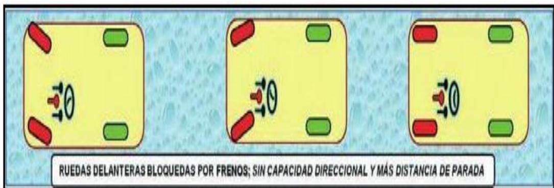
Figura 1.5 Ruedas delanteras bloqueadas
