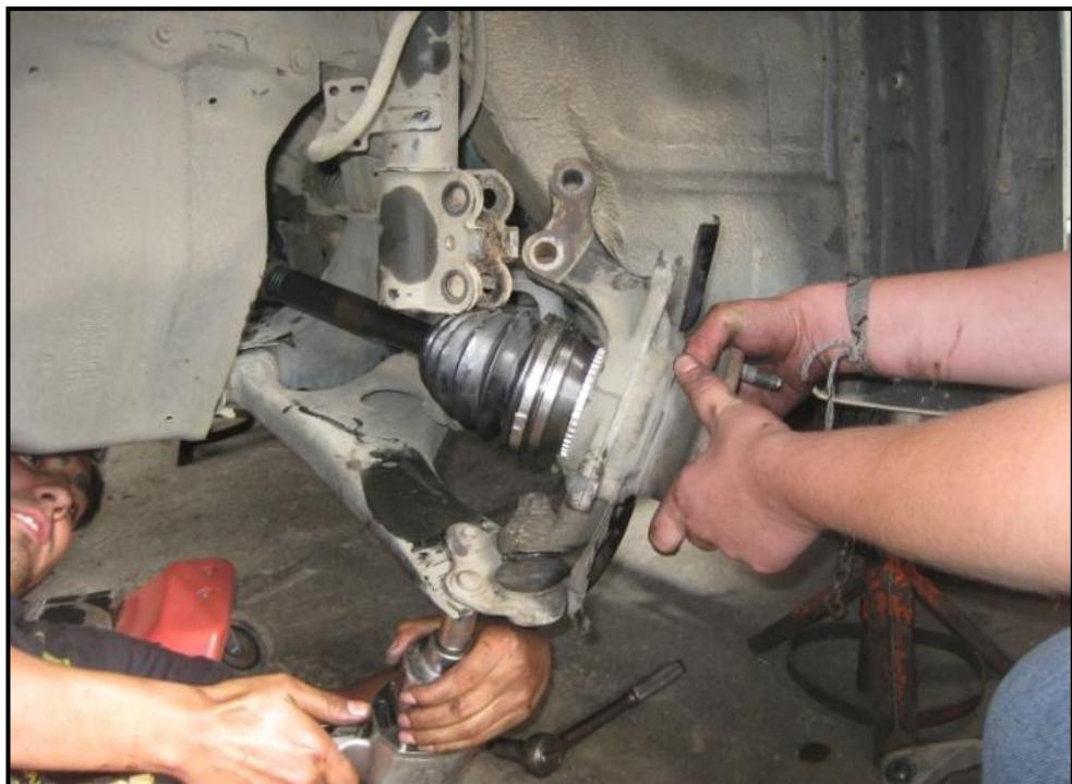
Figura 3.33 Armado de los semiejes
