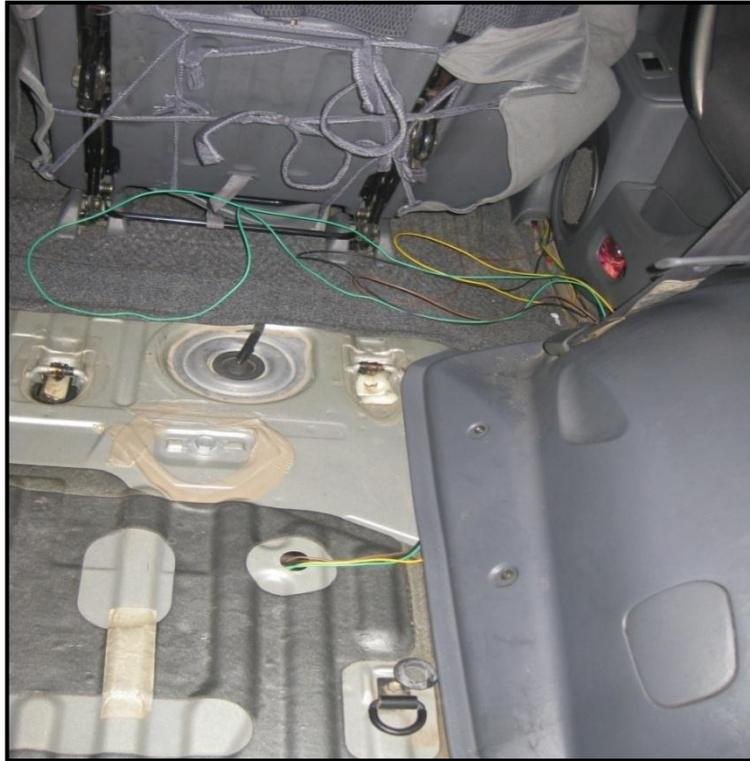
Figura 3.55 Cableado para conexión de los sensores posteriores
