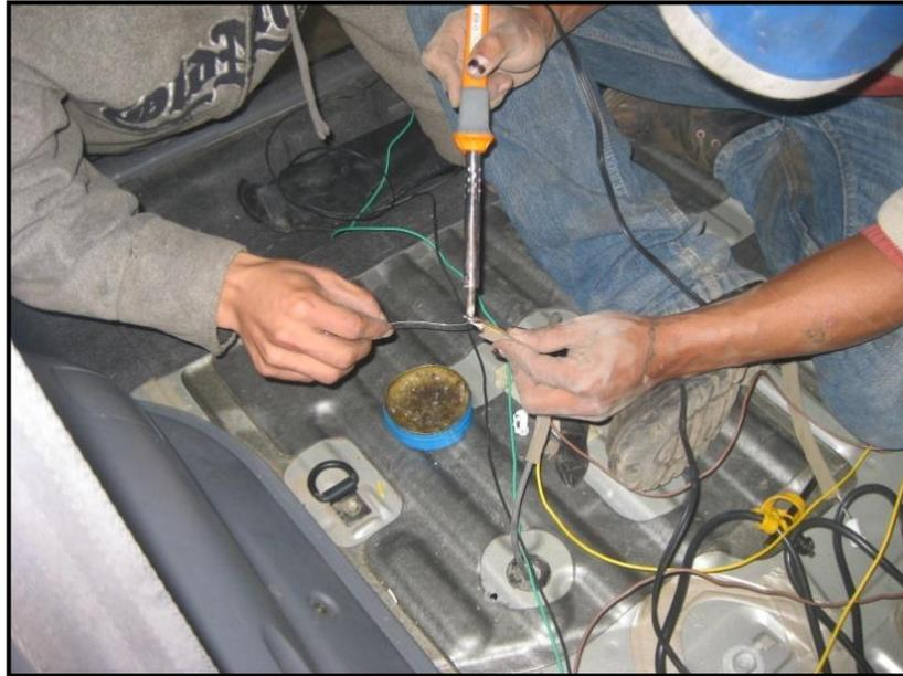
Figura 3.57 Soldado de los cables de conexión de los sensores posteriores
