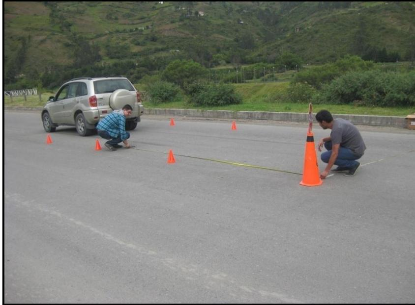
Figura 5.2 Medición de la distancia de frenado
