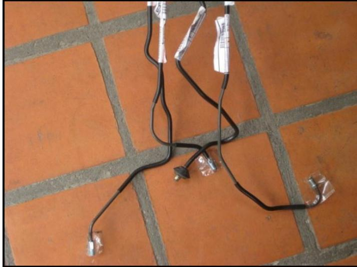
Figura 3.12 Cañerías de freno rígidas para el sistema ABS
