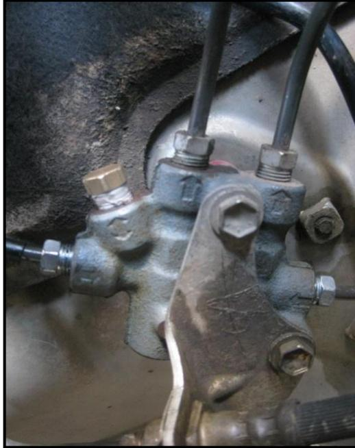
Figura 3.45 Válvula de doble proporción para el sistema ABS modificada
