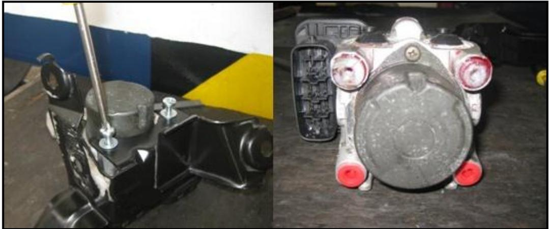
Figura 3.35 Bujes plásticos y colocación del módulo en el soporte
