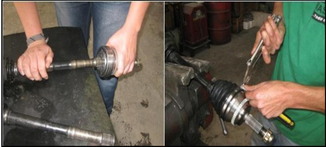
Figura 3.32 Colocado de las puntas y de los protectores de caucho
