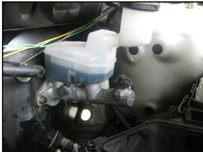
Figura 3.41 Cañerías y válvula retiradas del sistema de frenos
