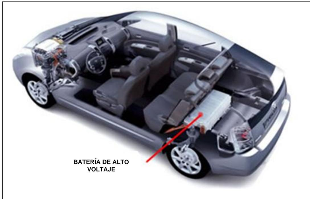
Figura 2.12. Batería de alto voltaje HV.
