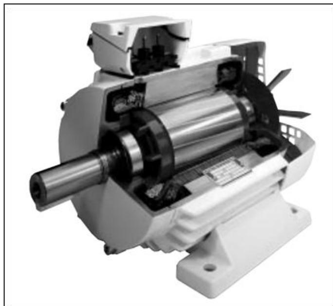
Las corrientes del rotor se inducen desde el estator a través del entrehierro. Tanto el estator como el rotor están fabricados de una lámina de núcleo altamente magnetizable. El bobinado del estator está formado por tres bobinados individuales que se superponen y están desfasados con un ángulo eléctrico de 120°. Cuando se conecta a la alimentación, la corriente de entrada primero magnetiza el estator. Esta corriente de magnetización genera un campo rotativo.
