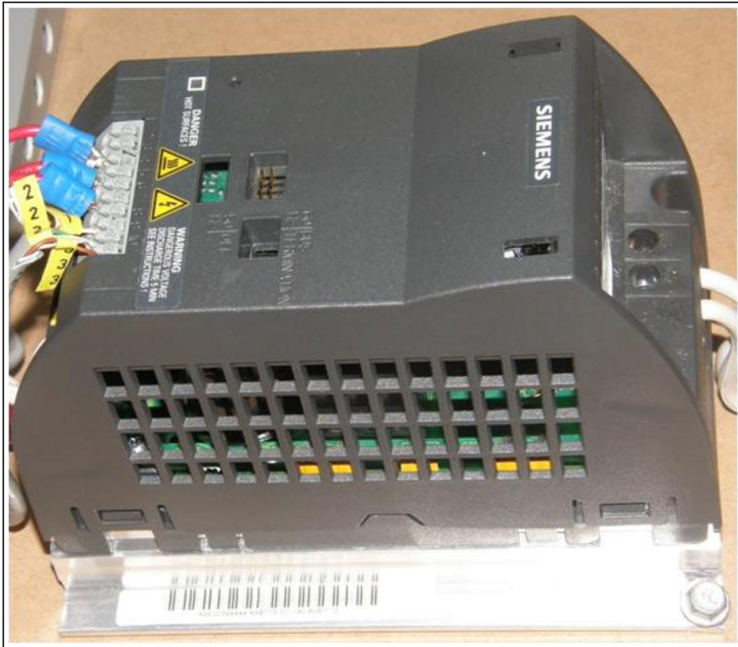
El driver se alimenta con una tensión monofásica de 220 VAC, generando en su interior la alimentación trifásica para motor eléctrico; este parámetro es una ventaja importante ya que permite comandar motores trifásicos aún cuando no está disponible la alimentación trifásica.
