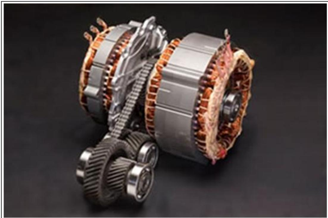
Siempre que el vehículo híbrido se encuentra en movimiento, la corona del engranaje planetario también se mueve. La fuerza para que la corona se mueva proviene del motor eléctrico (MG2) directamente o del empuje que le proporciona el motor de combustión interna. Cuanto más lenta es la velocidad del vehículo, tanto mayor fuerza proviene del motor eléctrico; mientras que si se aproxima a la velocidad máxima, toda la fuerza proviene del motor térmico.
