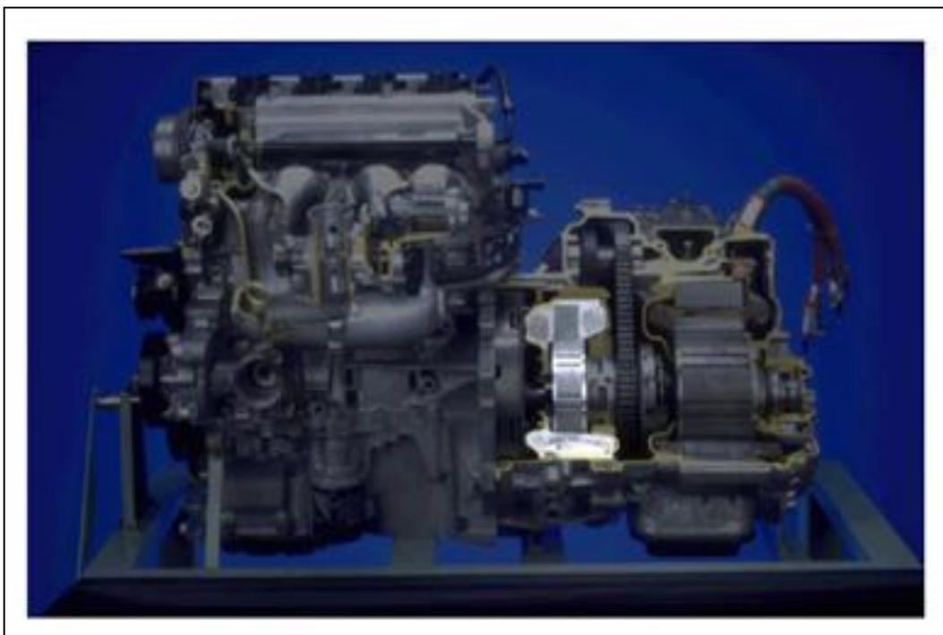
El moto generador 2 (MG2) se encarga de alternar con el motor de combustión interna el movimiento de las ruedas, ya sea marcha hacia adelante o marcha hacia atrás (reversa), todas estas condiciones de funcionamiento es controlada por la unidad de control electrónica del sistema híbrido (ECU HV).
