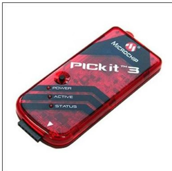
El PICKIT 3 es un programador fabricado por Microchip para programar toda su línea de microcontroladores PIC. Fue diseñado para programar los microcontroladores en circuito (ICSP) lo que significa que puede programar los microcontroladores montados directamente en cualquier aplicación y/o protoboard sin necesidad de tener que sacarlo y meterlo cada vez que se modifica el programa.
