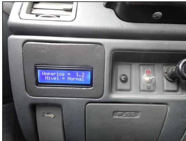
Fig. 3.23. Ubicación del amperímetro en la cabina
