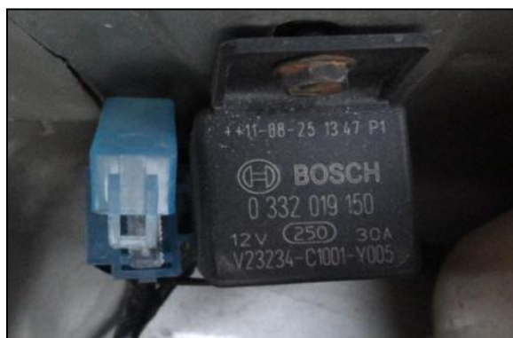
Fig. 3.19 Relé y fusible del sistema eléctrico
