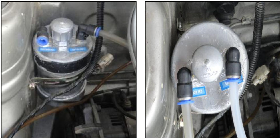
Fig. 3.22. Ubicación del atrapa llama en el habitáculo
