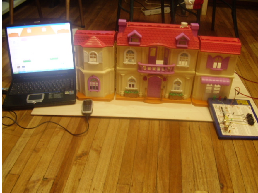
Sistema de control vía SMS
