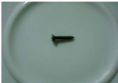
Tornillos pavonados avillanados con medida de 8*1.
