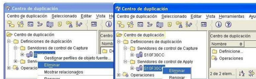
Figura 4.30: Eliminar los servidores de control de Capture y Apply
