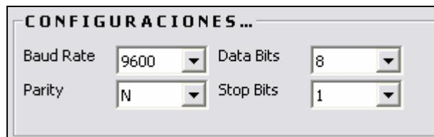
Figura 3.3 Parámetros de Configuración
