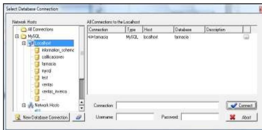
La ventana de Conexión a Bases de Datos tiene tres áreas, el Árbol de Servidores de Red, La Lista de Conexiones y la sección de Usuario/Password.
