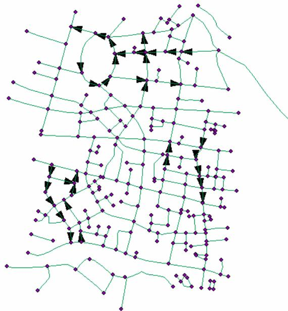
Figura 114. Ejemplo de configuración del atributo oneway
