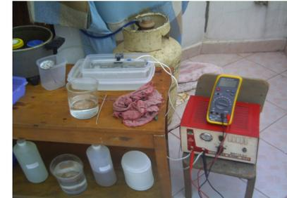
Preparación y conexión de la planta de electrólisis
