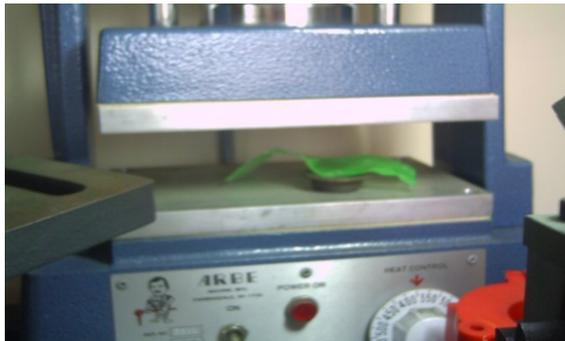
Termoformado con molde
