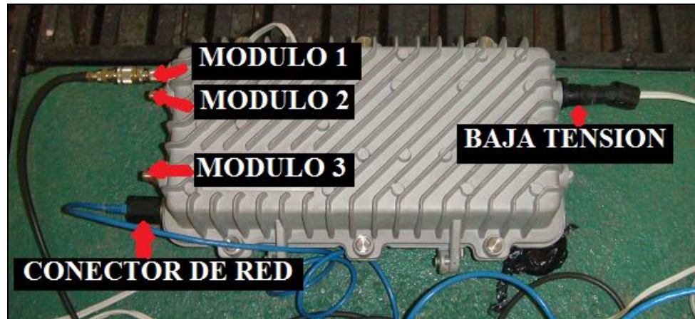
Fotografía 2.2: Equipo Repetidor de la Señal PLC
