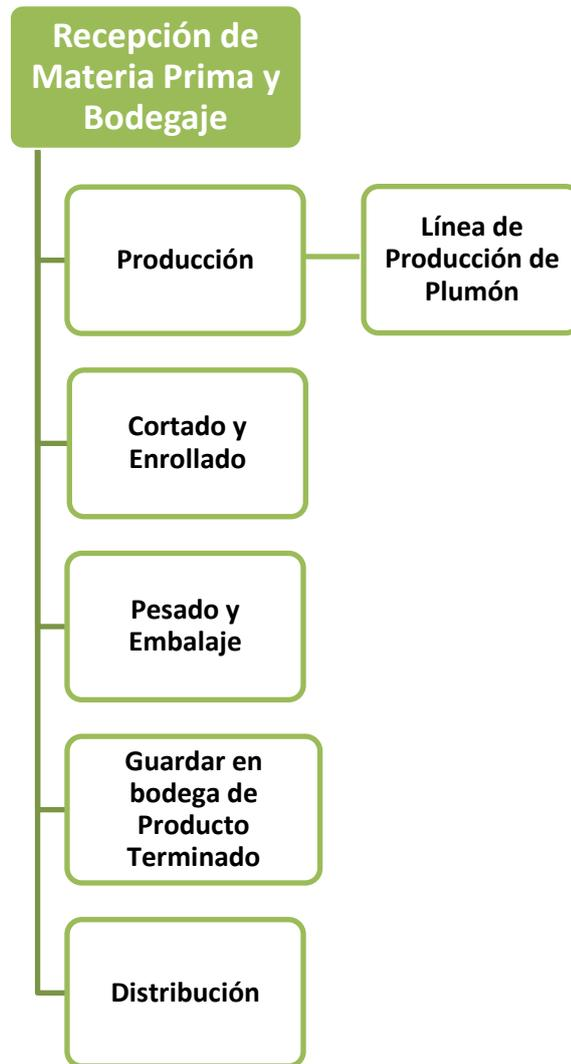
El flujo de producción en la Planta de Insomet, inicia con la recepción de materias primas, seguido de la revisión y comprobación del buen estado de las mismas; de esta manera se procede con el almacenamiento en bodega, para luego ser utilizadas en el proceso productivo del Plumón Sintético.
