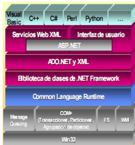
**Ilustración 4 Componentes .Net**
