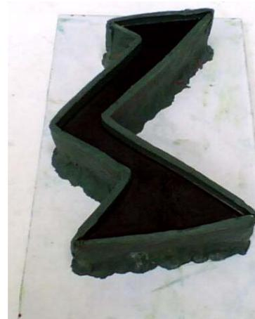
Posteriormente se realizan los moldes con la plastilina, sirviendo como estructura o soporte las piezas de madera y luego se vacía la resina
