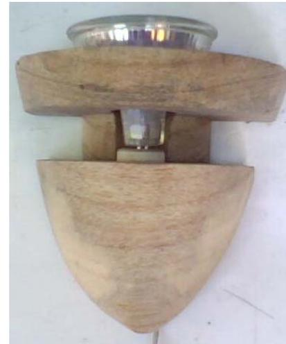
La parte inferior corresponde para la colocación de la boquilla en tanto que la parte superior sirve como protección de el dicroico (led); dando como resultado la pieza que irá empotrado en la pared
