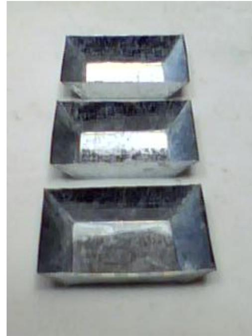
Por otro lado se cortan piezas de metal (láminas) como se ve en la imagen de la izquierda y posteriormente se hacen dobleces para llegar a obtener las piezas que se ven en la imagen de la derecha.
