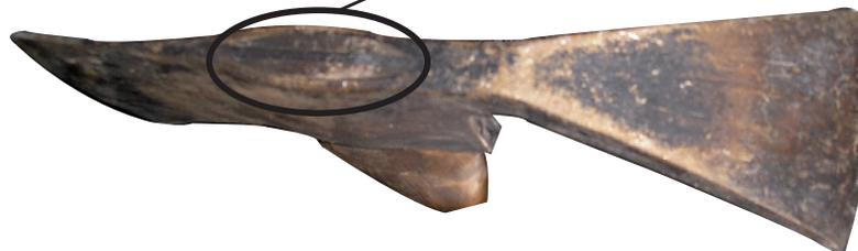
El mango en su parte inferior es de forma elíptica y es ajustada con una cuña metálica.
