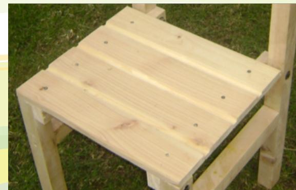
enfoque de la forma; como se puede notar en las imágenes los tableros o asientos por lo general son de madera o de plywood unidos mediante clavos tapando las imperfecciones con masilla, de lo contrario las nuevas propuestas plantean mostrar cómo se estructura dejando como un detalle los tornillos y los pernos.
