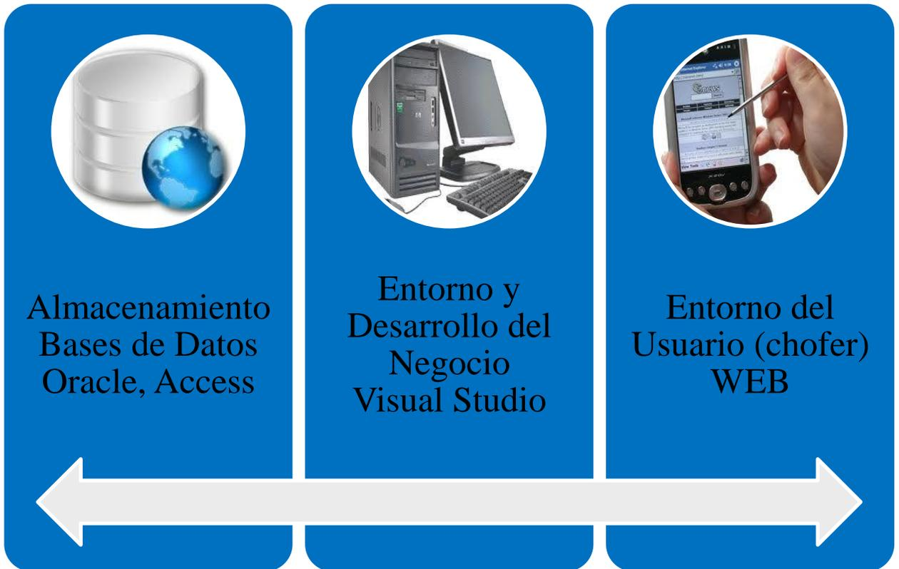
Figura 19. Esquema de la Arquitectura en Tres Capas
