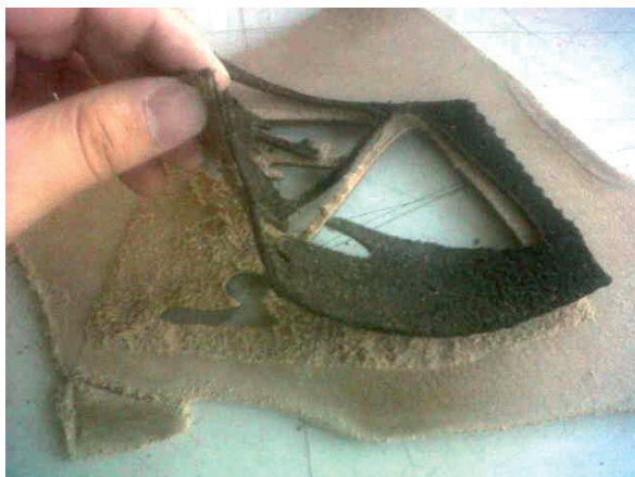
Detalle despegue del cuero sobre la suela
