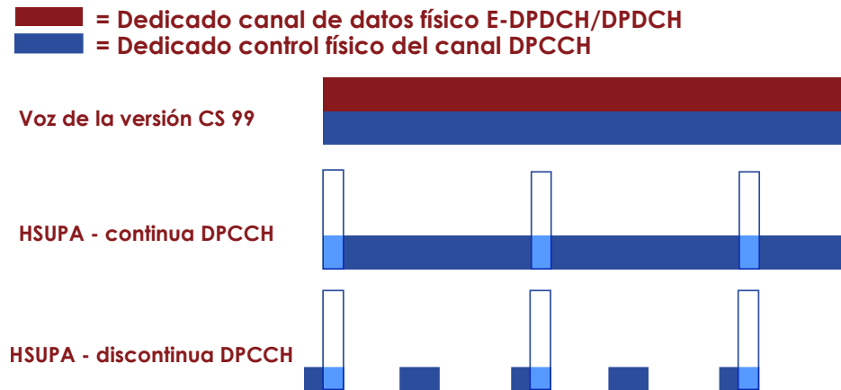
Gráfico 1.31 Transmisión discontinua DPCCH de enlace ascendente para el servicio de voz
