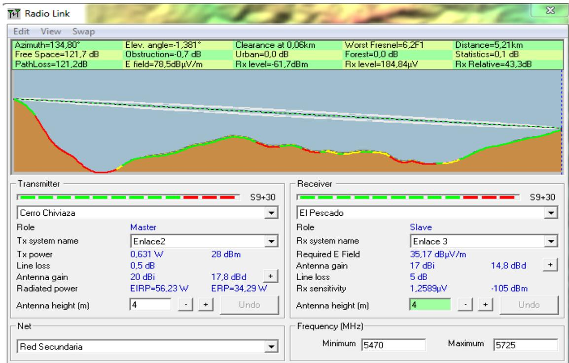
Debido a la línea de vista sin interferencia el enlace alcanza una gran estabilidad y sus niveles de potencia al receptor son lo bastante considerables como para garantizar que los equipos a utilizar tendrán un buen rendimiento.
