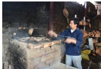
Observamos al Sr. Ivan Encalada retirando las piezas de ceramica del horno despues de 4 horas de coccion.
