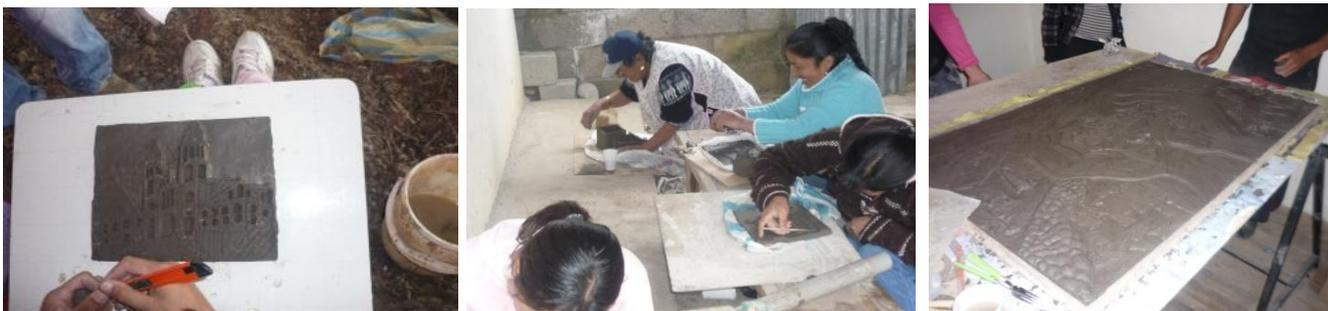
En estas fotografías se puede observar como desbastan y pulen las piezas antes de dejarle a secar y posteriormente para la cocción en el horno.
