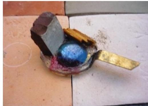
En esta fotografia ,observamos el resultado de la vinculacion de muestras de ceramica , madera, cobre, vidrio aplicando con vidrio liquido.
