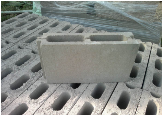
Imagen 59: Bloque de hormigón
