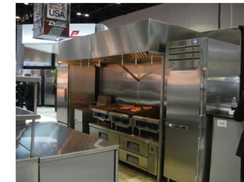
Foto 70. Equipos con ventilación incluida
