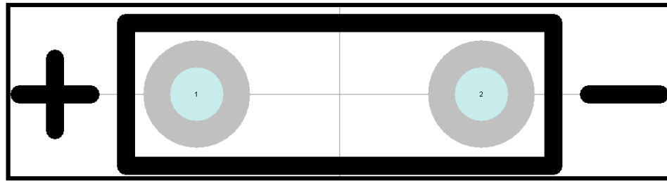
Figura 5.4 Footprint de la Batería
