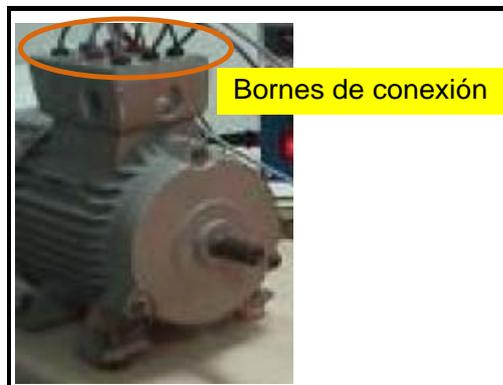
La conexión de sus devanados, se realiza en triángulo para la velocidad menor y en doble estrella para la mayor.
