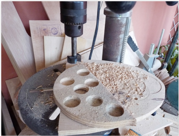
Proceso de perforado en plywood
