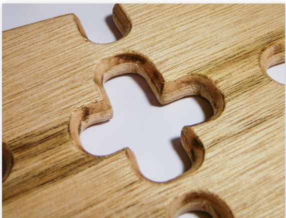
Redondeado de caladuras
