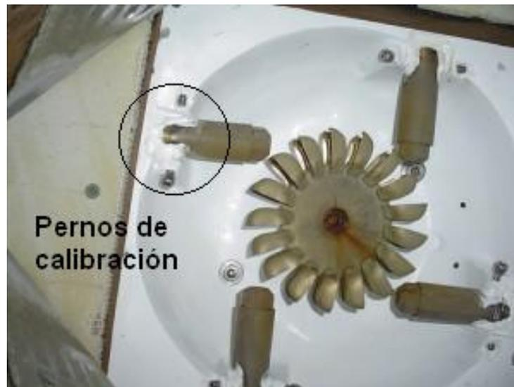
**Figura #22** Pernos de calibración internos del inyector.
