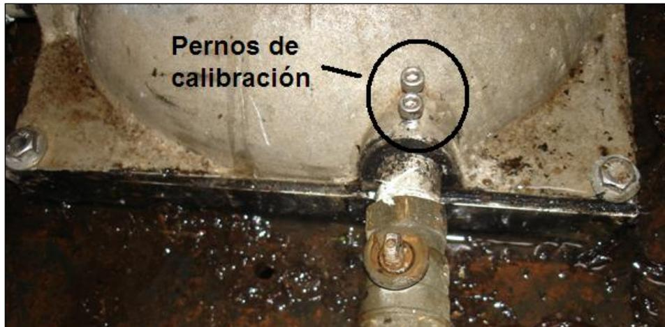
**Figura #21** Pernos de calibración externos del inyector.
