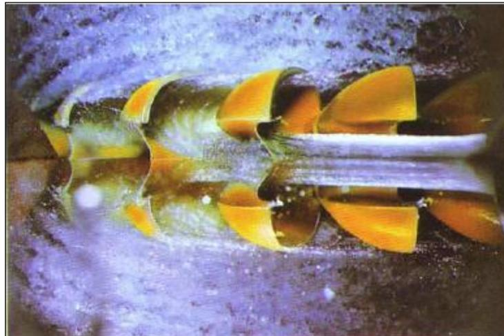
**Figura #6** Foto de una rueda Pelton en funcionamiento.
