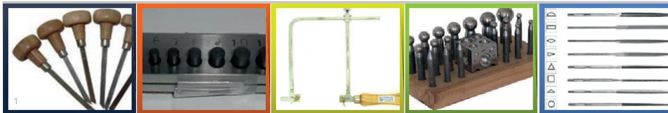
Se utilizan varios instrumentos como: cuños, cortadores, troqueles, moldes que por medio de golpe o presión se impregna una figura, también se utiliza limas planas, de media caña, buriles, tenacillas, martillos, sopletes, sierras, todos estos entran en juego a la hora de que un artesano cuencano desea plasmar una joya. Estas técnicas a pesar de básicas, son las que vienen de generación en generación lo largo de la historia, y hace que la joyería cuencana tenga renombre.
