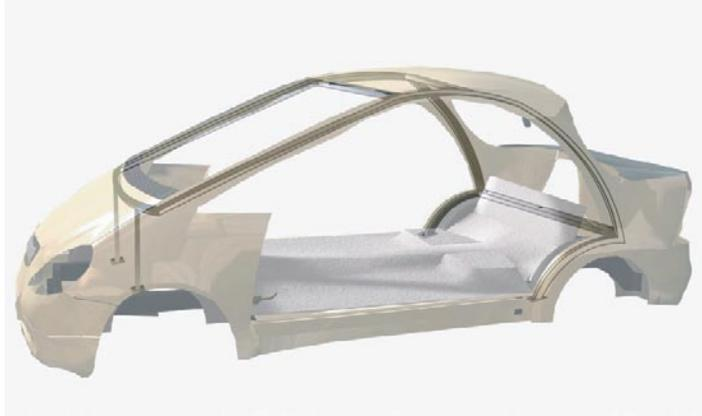
Unión de la armadura con la carrocería por medio de (Sicaflex) pegamento de fibra y metales
