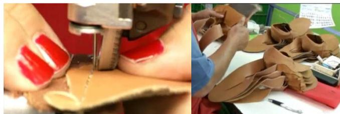
En la parte delantera se debe insertar la puntera que proporciona soporte a la punta del calzado, y el contrafuerte en la parte trasera de la capellada para dar soporte al talón.
