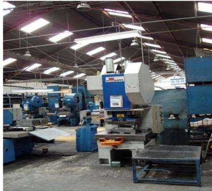
*Fotografía 1-3. Troqueladora - Sección Metalmecánica.*
