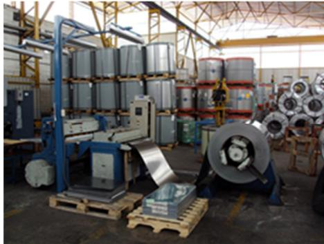
Fotografía 1- 1.Tren de Desbobinado- Sección Metalmecánica.
