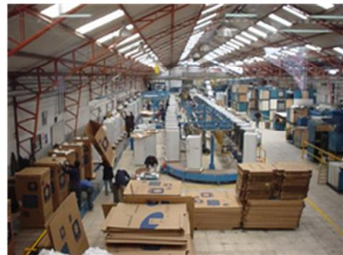
*Fotografía 1-12. Línea de Ensamble de Refrigeradoras – Sección refrigeración.*
