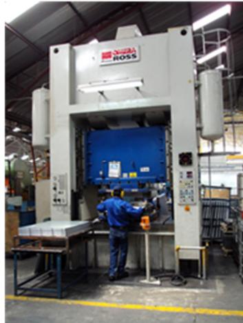
*Fotografía 1- 2. Prensa Hidráulica - Sección Metalmecánica.*
