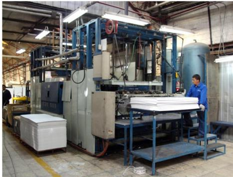
*Fotografía 1-9. Termoformadora – Sección refrigeración.*
