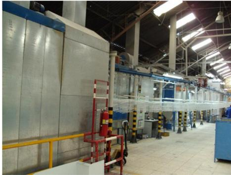
*Fotografía 1-7. Cabina de aspersión - Sección Tratamiento de superficies.*
