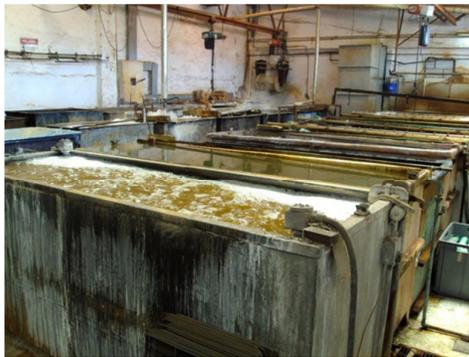
*Fotografía 1-5. Galvanizado - Sección Tratamiento de superficies.*
