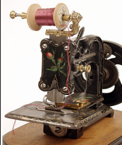
Máquina Willcox y Gibbs, con un sistema de cadena.
