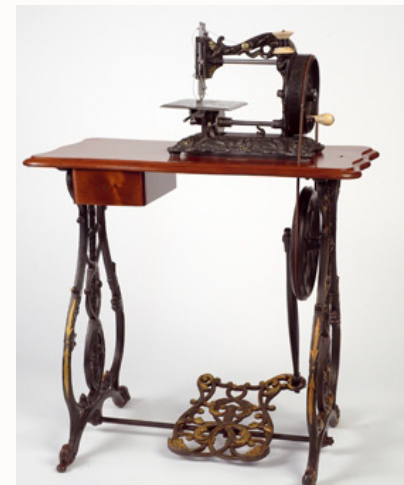
Esta máquina realizaba una puntada cerrada con dos hilos: el transportado por la aguja y el de la lanzadera
