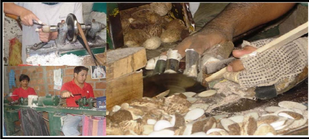
**Figura 15: Desecho de Tagua después del proceso de extracción de botón**
