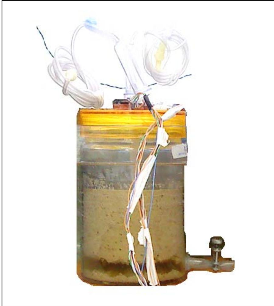
**Fotografía 6.4.-** Biodigestor con materia orgánica
