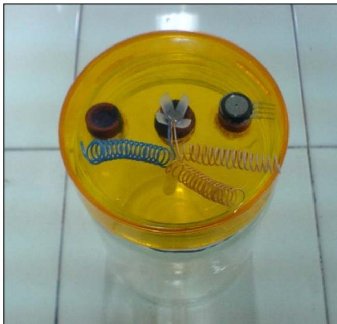
**Fotografía 6.2.-** Tapa del biodigestor con los sensores de presión y temperatura montados
