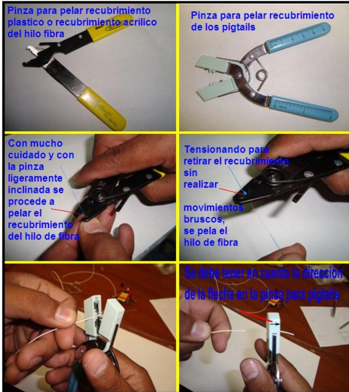
Figura A1.18. Utilización de las pinzas para pelar los hilos de fibra óptica.
