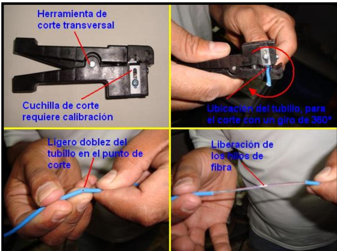
**Figura A1.12.** Herramienta de corte transversal, liberación de los hilos de fibra.
