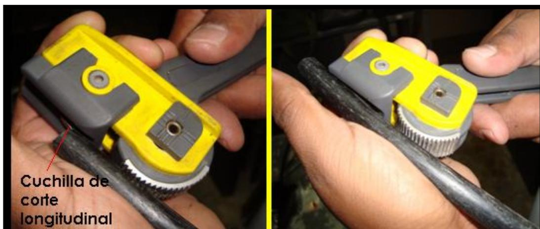
Figura A1.4. Uso de la cuchilla de corte longitudinal.
