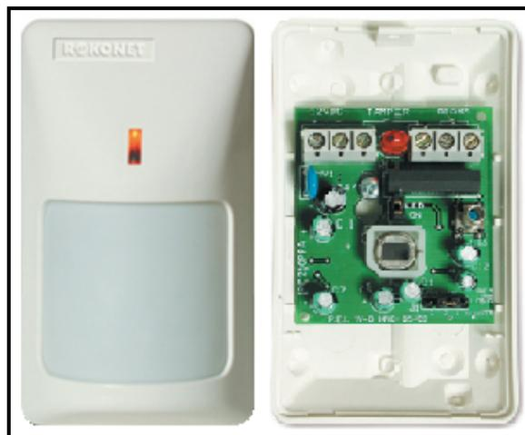
**Figura 3.10 Sensor de Movimiento Rokonet Comet PIR RK210PR**
