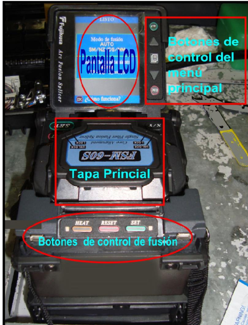
Figura A1.16. Vista frontal de la Fusionadora FUJIKURA FSM60S.
