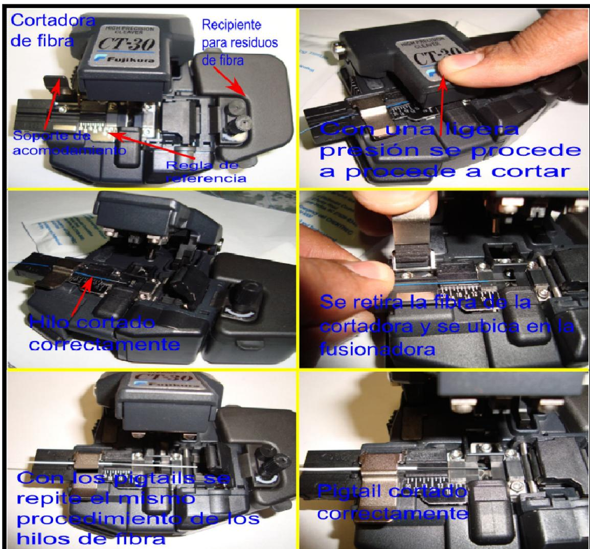
Figura A1.20. Corte de hilos de fibra y pigtails previo a la fusión.
