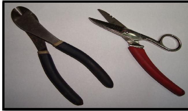
Figura A1.2. Tijeras metálicas, alicate o cortafrío.
