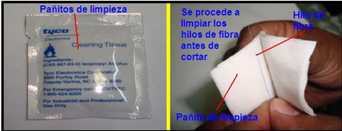
Figura A1.19. Limpieza de la fibra antes de proceder con el corte.
