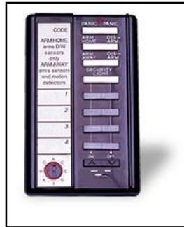
Figura 2.16: Powerhouse de seguridad y control SH624
