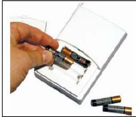
Figura 2.5: Colocación de 3 pilas AAA alcalinas
