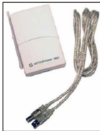
Figura 2.2: Interface CM15A con cable USB
