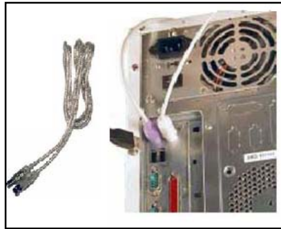
Figura 2.3: Conexión del cable USB a la computadora
