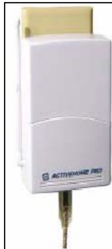
Figura 2.6: Conexión de la Interface CM15A al Tomacorriente.
