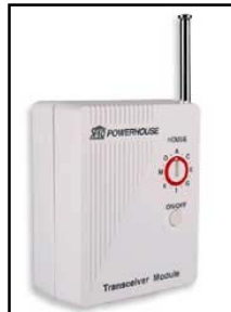
Figura 2.17: Módulo de transceptor inalámbrico TM751
