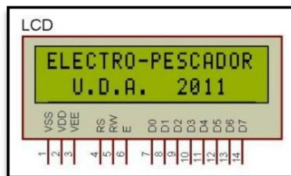
Figura 3.2. Cartel de inicio en el LCD. Simulación con PROTEUS
