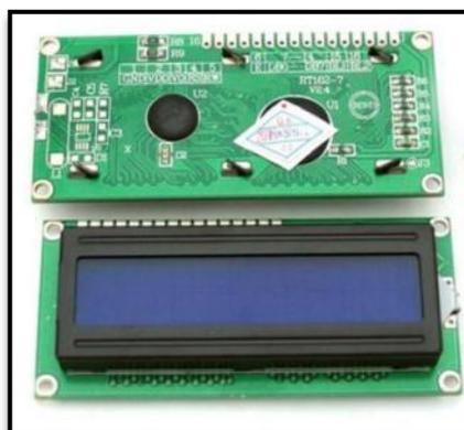
**Figura 1.23.** LCD 2x16 con *backlight* azul utilizado en este proyecto
