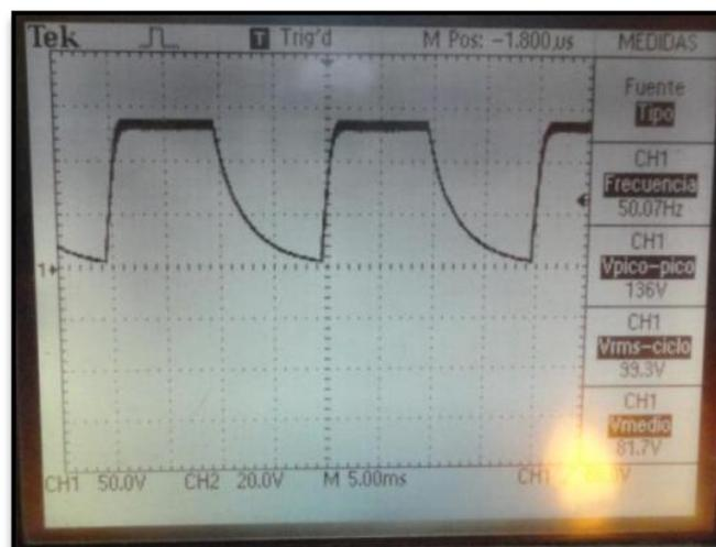
**Figura 4.5.** Señal de salida conectada a una carga de aprox.  $180\Omega$
