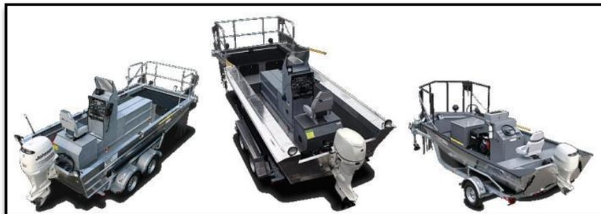
**Figura 1.11.** Equipos de electropesca instalados en botes (*stunboat*)
