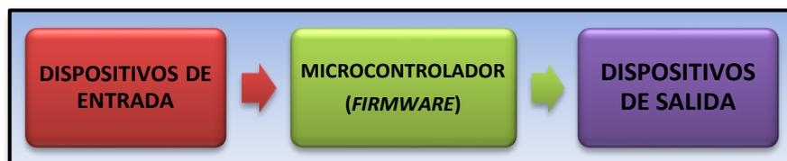
**Figura 1.12.** Diagrama de bloques de un sistema microcontrolado
