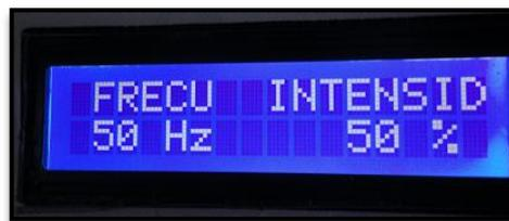
**Figura 4.2.** Valores de frecuencia y ciclo útil iniciales mostradas en el LCD
