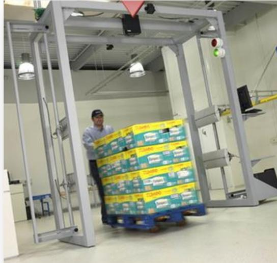
**Figura 1.31** Sistema RFID para control de bodegas
