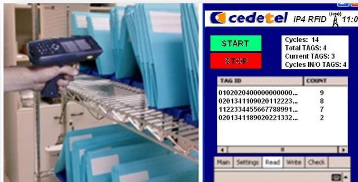
**Figura 1.28** Sistema RFID para control de archivos.
