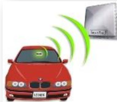
**Figura 1.20** Lectura utilizando sistemas RFID.
