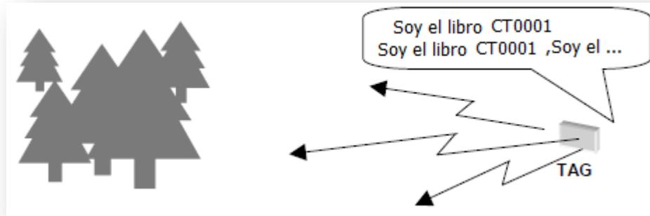
**Figura 1.10** Tag activo con alimentación propia, permanece encendido aunque no exista un lector emitiendo energía cerca a él, responde mejor en ambientes hostiles.
