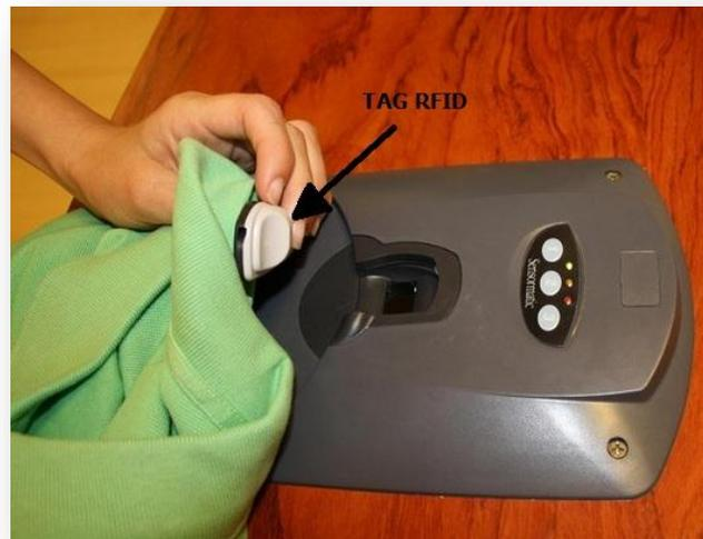
**Figura 1.4** Aplicación de RFID para control de almacén de ropa.
