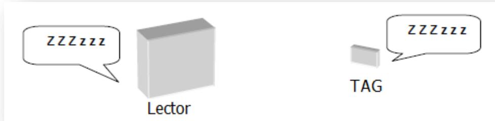
**Figura 1.14** El tag pasivo permanece apagado al no encontrarse dentro del rango de lectura.
