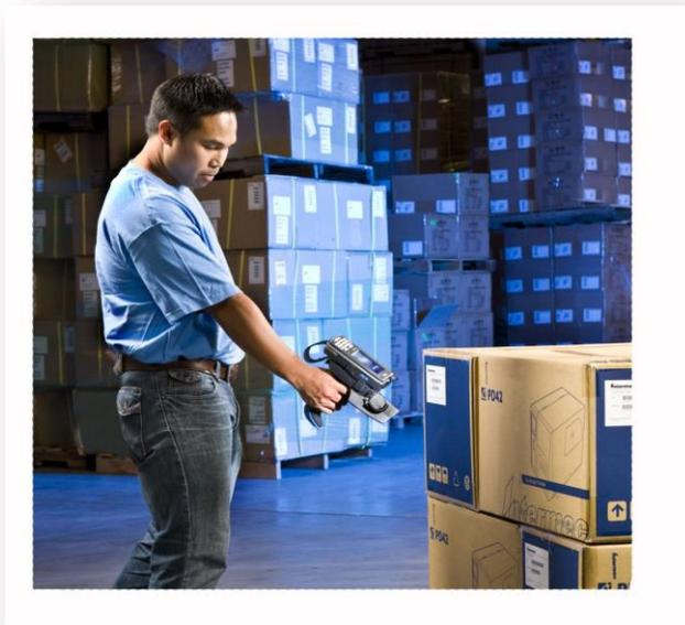
**Figura 1.26** Para un control de inventarios se puede utilizar un lector RFID manual.
