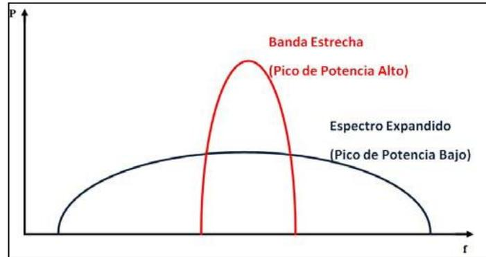
Figura 28: Espectro Expandido vs. Banda Estrecha en el Dominio de Frecuencia
