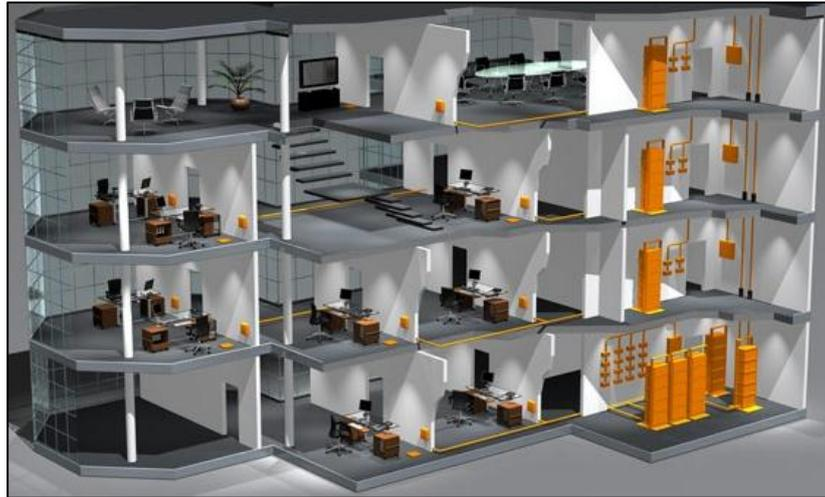
Figura 67: Sistema de cableado estructurado
