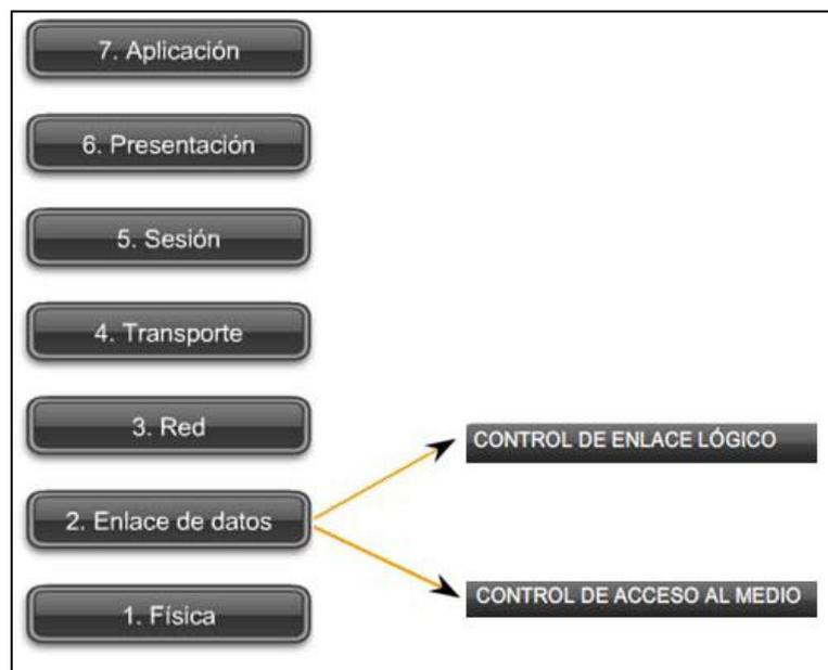
Figura 29: Modelo de Referencia OSI
