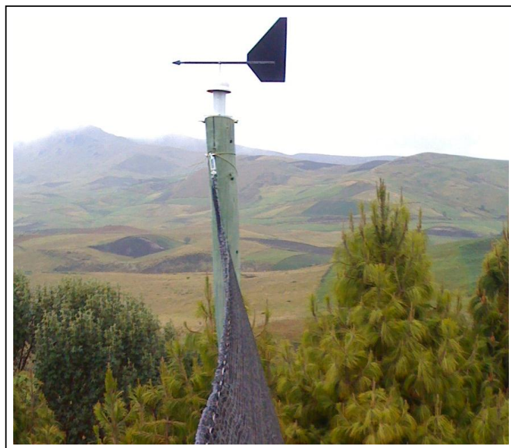
Figura #117: Montaje del sensor de dirección de viento.
