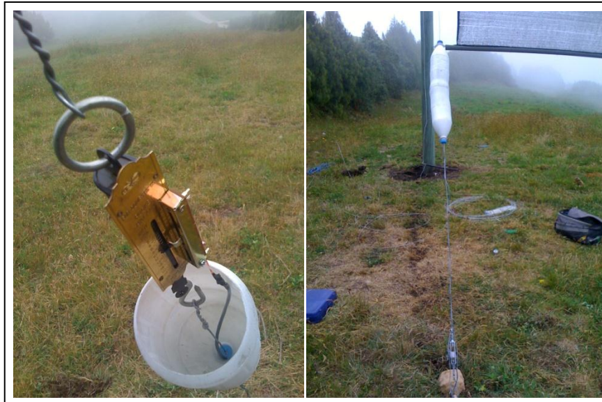
Figura #127: Montaje del sensor de tensión en cables.
