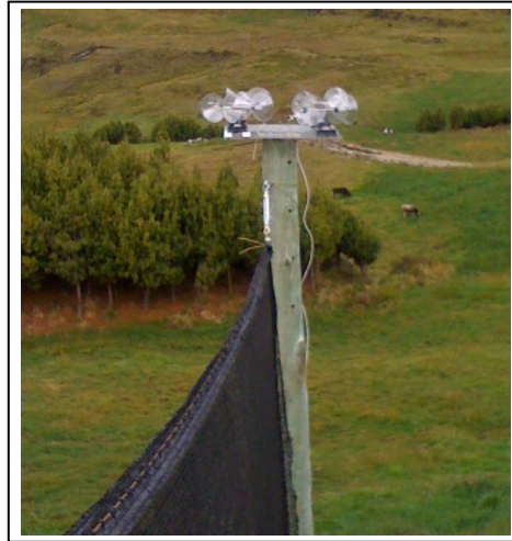
Figura #114: Montaje de los sensores en uno de los postes.
