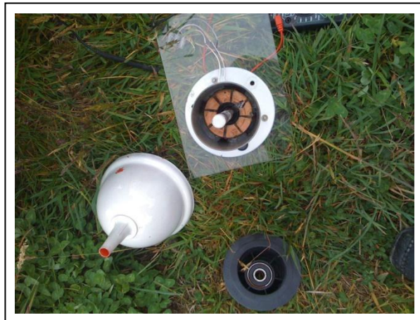
Figura #116: Construcción del sensor de dirección de viento.
