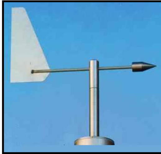
Figura #79: Veleta de metal y plástico
