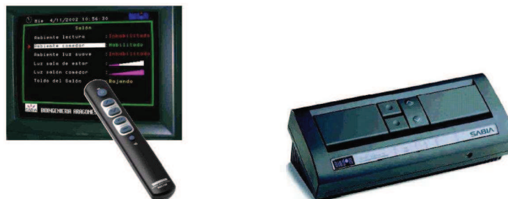
Fig. 2-5. Gestor domótico Biodom y su interfaz en el TV. Fuente: http://bioingenieria.es/BioDom/BioDom.htm
