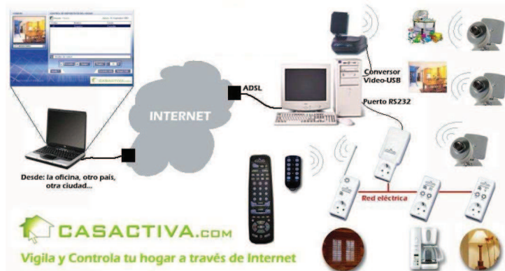
Fig. 3-1. Instalación basada en X10.
