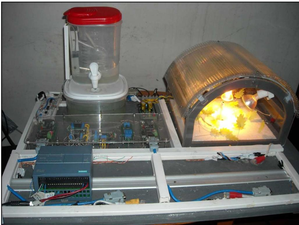
**Figura 5.3:** Imagen de la maqueta de la práctica demostrativa del “control de temperatura y llenado de un tanque de agua”.
