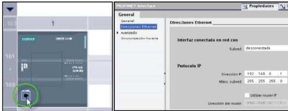
**Figura 2.9:** Configuración de la direcciones IP en el puerto PROFINET de la CPU.
