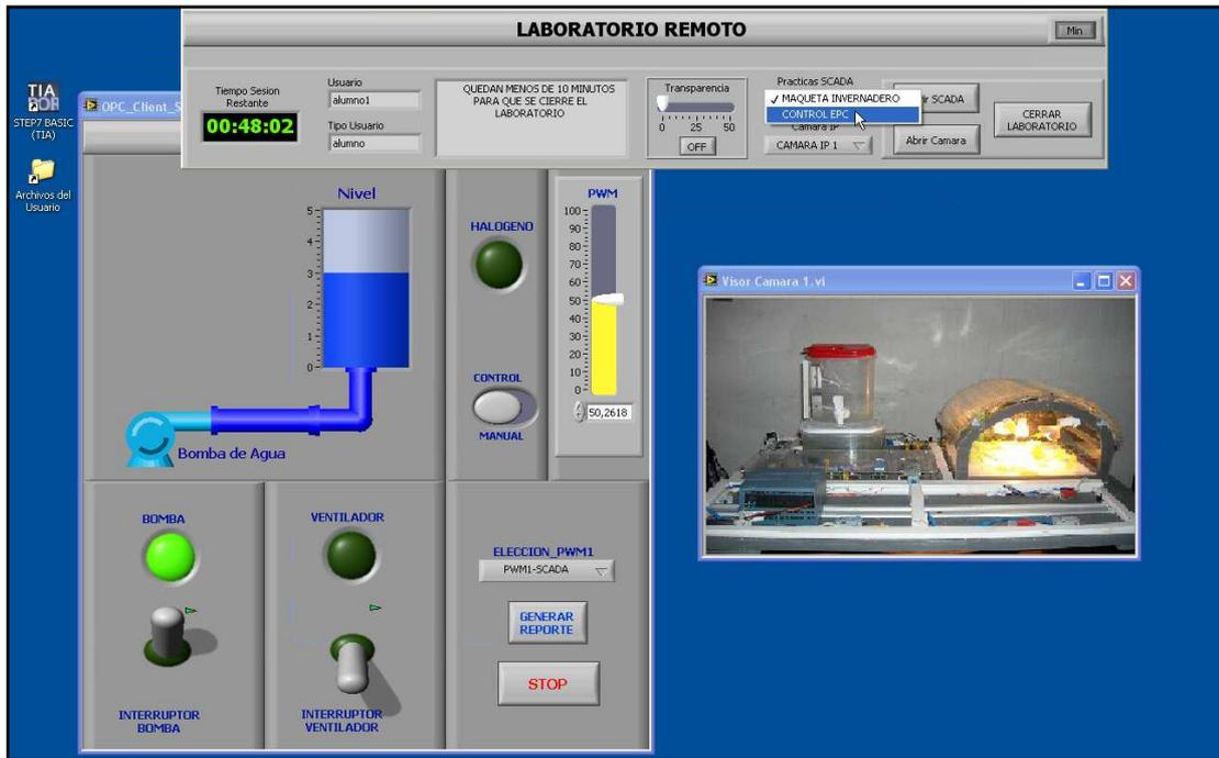
Figura 5.34: Monitoreo y control del SCADA de una práctica junto con el visor de la cámara IP, utilizando la interfaz de acceso remoto.
