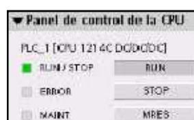
**Figura 2.12:** Panel de control de la CPU, para el estado de operación.
