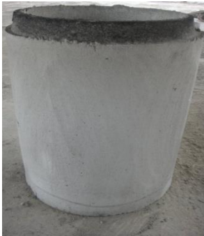
Fotografía de tubo de 80 de hormigón simple y armado de 0,80m de diámetro tipo espiga campana.
