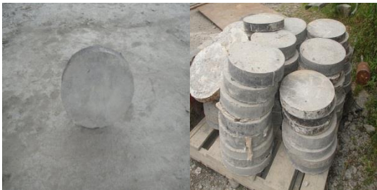
Fotografía de tapa de 0.40 cm de diámetro de hormigón armado y simple y con platina, cónicas y rectas.
