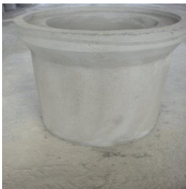
Fotografía de tubo de 70 de hormigón simple y armado de 70cm de diámetro, espiga campana.
