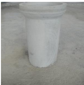
Fotografía de tubería de hormigón simple y armado de 30cm de diámetro, espiga campana.
