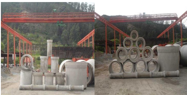
Fotografía de tubos de clase III con untas de neopreno.
