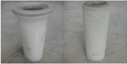
Fotografía de tubería de hormigón simple y armado de 20cm de diámetro, campana espiga.
