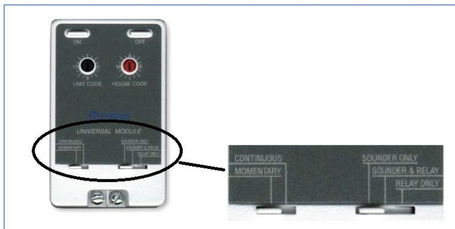
Figura 4.11 Modulo X10 Universal PUM01 – imagen ampleada de los selectores
