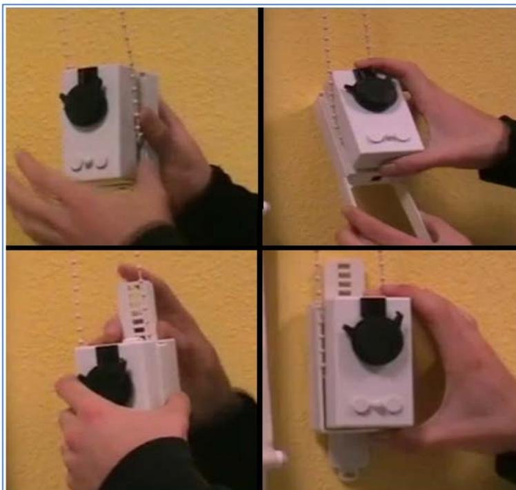
Figura 3.4. Instalación del Motor ADD 80.
