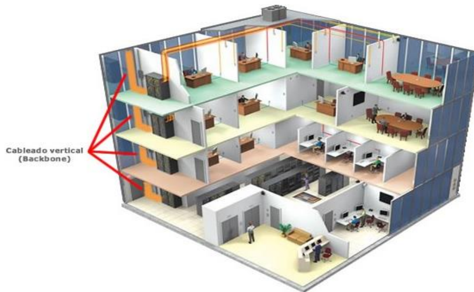
Figura 23. Cableado Vertical (Gomez, 2011)
